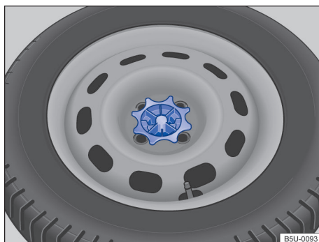
Fig. 194 En el maletero: manivela para fijación de la rueda de emergencia.
