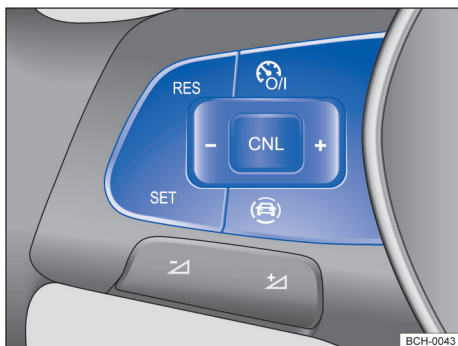
Fig. 97 Lado izquierdo del volante multifunción (variante 1): teclas para controlar el limitador de velocidad.
