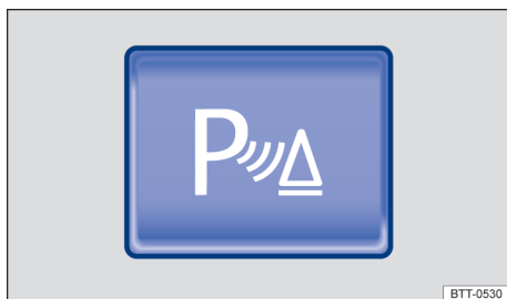
Fig. 105 En la consola central: tecla de encender y apagar la ayuda de estacionamiento (dependiendo de la versión del vehículo).
