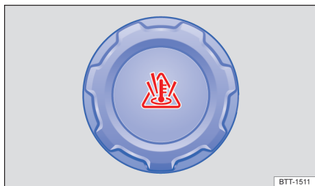
Fig. 186 En el compartimento del motor: tapa del depósito de expansión del líquido refrigerante del motor.
