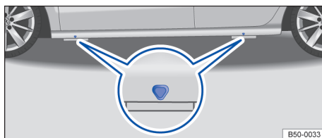
Fig. 197 Puntos de apoyo del gato.
