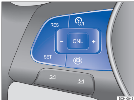
Fig. 95 Lado izquierdo del volante multifunción (variante 1): teclas para controlar el GRA
