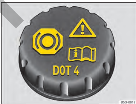
Fig. 237 En el vano motor: tapa del depósito del líquido de frenos.
