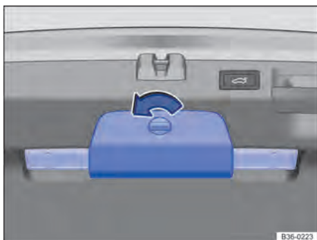
Fig. 59 En el portón del maletero: soporte del triángulo de preseñalización (Variant).
