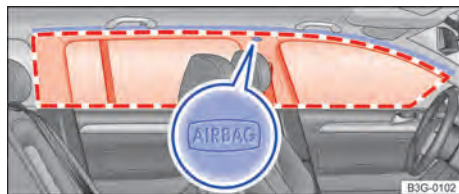
Fig. 48 En el lado izquierdo del vehículo (Variant): ubicación y zona de despliegue del airbag para la cabeza.
