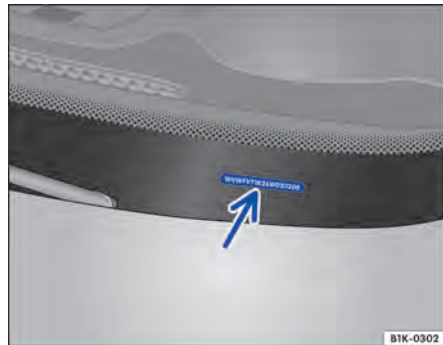
Fig. 264 En el parabrisas: número de identificación del vehículo.
