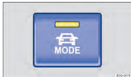
Fig. 130 En la consola central: tecla MODE para seleccionar los perfiles de conducción.
