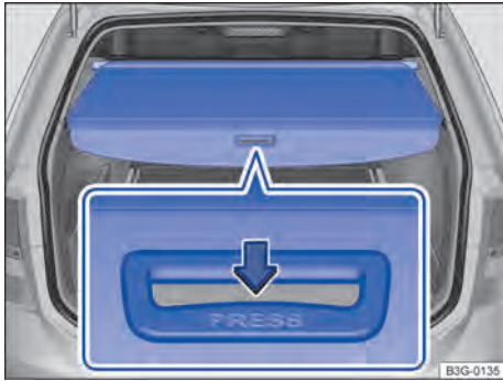
Fig. 169 En el maletero: abrir la cubierta del maletero.
