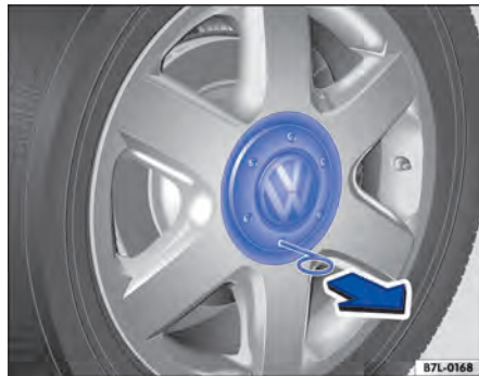
Fig. 246 Desmontar el tapacubos central tirando de él.
