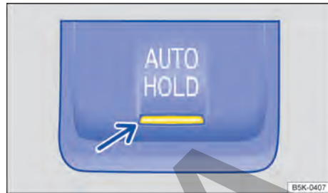
Fig. 146 En la consola central: tecla de la función Auto-Hold.
