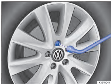
Fig. 257 Cambio de rueda: desenroscar los tornillos de rueda con la llave de rueda.
