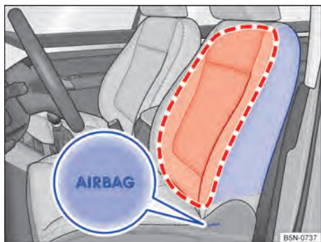
Fig. 46 Lateral de un asiento delantero: ubicación y zona de despliegue del airbag lateral.
