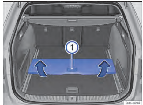
Fig. 177 En el maletero: desmontar el piso desplazable del maletero.
