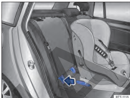
Fig. 56 Representación esquemática: montaje de un asiento para niños con conectores.
