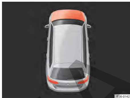
Fig. 230 En la pantalla del cuadro de instrumentos: capó del motor abierto o no cerrado correctamente (representación esquemática).
