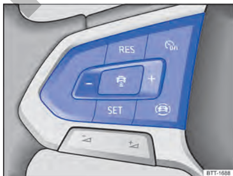
Fig. 139 Lado izquierdo del volante multifunción: teclas para manejar el ACC.
