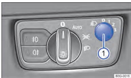
Fig. 101 Junto al volante: regulador del alcance de las luces.
