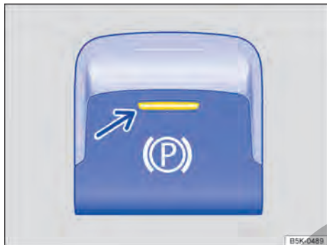
Fig. 145 En la consola central: tecla del freno de estacionamiento electrónico (representación esquemática).
