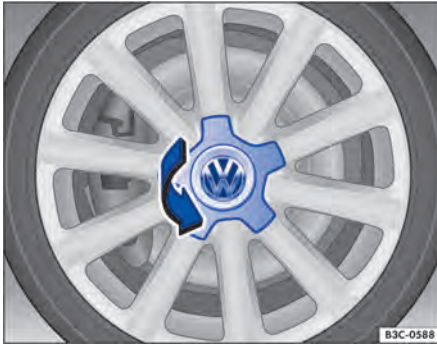
Fig. 247 Desmontar el tapacubos central girándolo.
