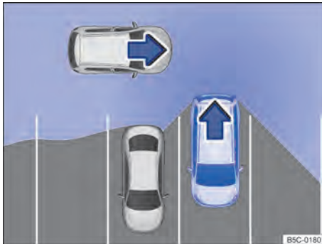
Fig. 158 Representación esquemática del asistente de salida del aparcamiento: zona vigilada alrededor del vehículo que está desaparecando.
