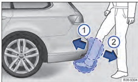
Fig. 75 Portón del maletero con apertura controlada por sensores (Easy Open).
