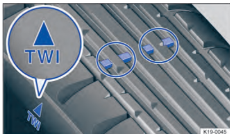
Fig. 244 Perfil del neumático: indicadores de desgaste.
