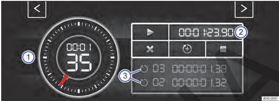
Fig. 26 En la pantalla del sistema de infotainment: cronómetro, botones de función y tiempos de las vueltas.
