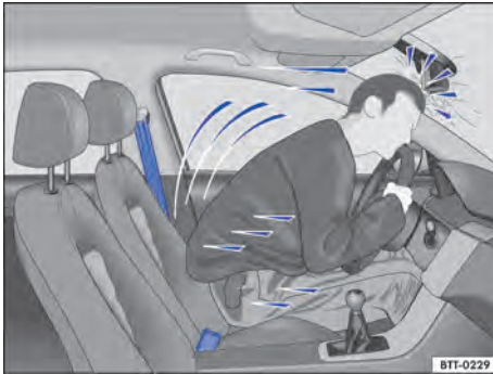
Fig. 33 El conductor sin el cinturón de seguridad colocado sale lanzado hacia delante.
