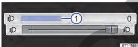
Fig. 102 En el sistema de infotainment: botón desplazable para regular el alcance de las luces.
