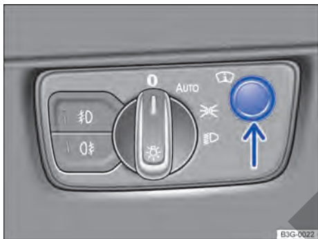
Fig. 20 Junto al volante: regulador del Head-up-Display (flecha).
