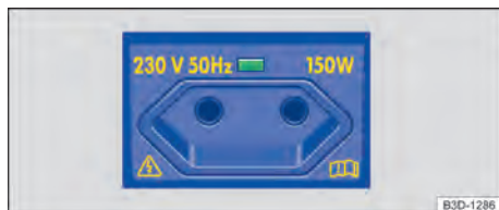
Fig. 162 En la parte trasera de la consola central (en función del equipamiento): toma de corriente de 230 voltios.
