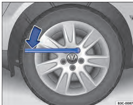
Fig. 250 Cambio de rueda: aflojar los tornillos de rueda.
