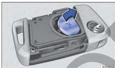
Fig. 65 Llave del vehículo: cambiar la pila de botón.
