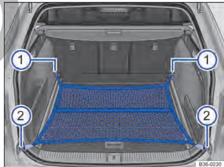
Fig. 187 En el maletero: bolsa de red enganchada a ras del piso.
