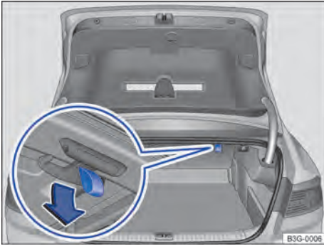
Fig. 194 En el maletero, en la parte superior derecha: gancho para bolsas.
