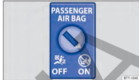
Fig. 44 En el tablero de instrumentos, en el lado del acompañante: conmutador de llave para desactivar y activar el airbag frontal del acompañante.
