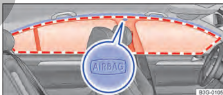
Fig. 47 En el lado izquierdo del vehículo (berlina): ubicación y zona de despliegue del airbag para la cabeza.
