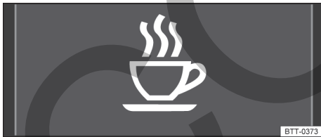
Fig. 22 En la pantalla del cuadro de instrumentos: símbolo de detección del cansancio.
