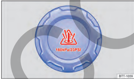
Fig. 236 En el vano motor: tapa del depósito de expansión del líquido refrigerante del motor (representación esquemática).
