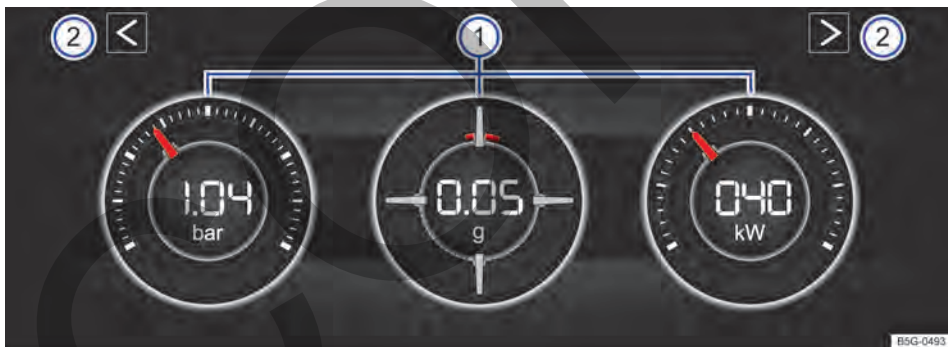
Fig. 25 En la pantalla del sistema de infotainment: monitor de potencia.
