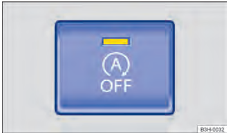
Fig. 123 En la parte inferior de la consola central: tecla del sistema Start-Stop.
