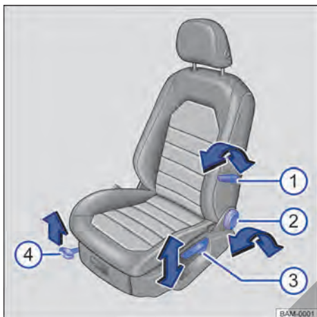
Fig. 82 En el asiento delantero izquierdo: mandos (variante 1).
