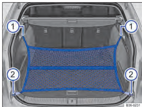
Fig. 188 En el maletero: bolsa de red enganchada delante del umbral de carga.
