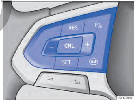
Fig. 134 Lado izquierdo del volante multifunción: teclas para manejar el regulador de velocidad.
