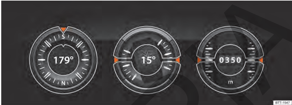
Fig. 131 En el sistema de infotainment: indicador Offroad.
