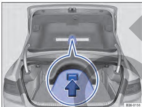
Fig. 60 En el portón del maletero: soporte del triángulo de preseñalización (berlina).
