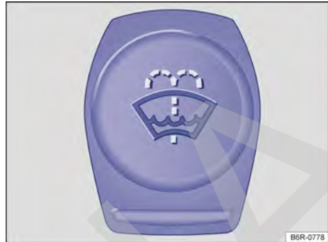
Fig. 235 En el vano motor: tapa del depósito del líquido lavacristales.
