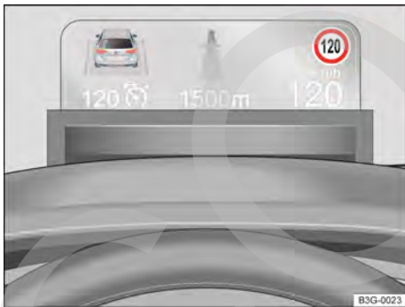
Fig. 16 En el tablero de instrumentos, encima del volante: ejemplos de indicaciones en el Head-up-Display.
