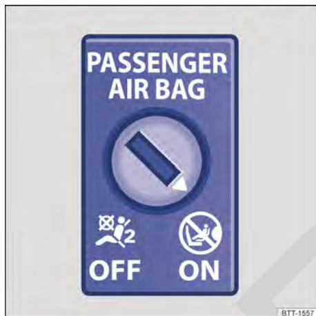
Fig. 47 En el tablero de instrumentos del lado del acompañante o en la guantera: conmutador de llave para activar y desactivar el airbag frontal del acompañante.
