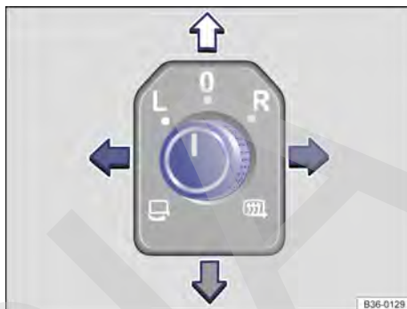
Fig. 111 En la puerta del conductor: mando giratorio de los retrovisores exteriores.
