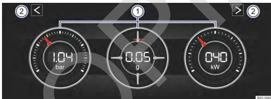
Fig. 28 En la pantalla del sistema de infotainment: monitor de potencia.
