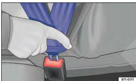
Fig. 39 Insertar la lengüeta del cinturón de seguridad en su cierre.
