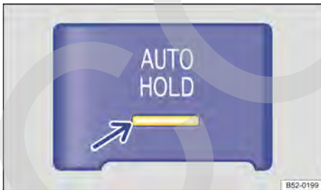
Fig. 155 En la consola central: tecla de la función Auto-Hold.
