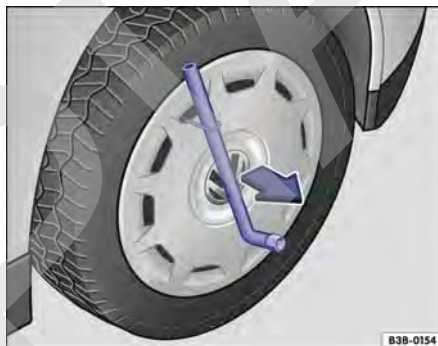
Fig. 251 Desmontar el tapacubos integral.
