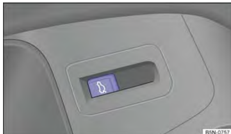
Fig. 72 En la puerta del conductor: tecla de desbloqueo del portón del maletero.
