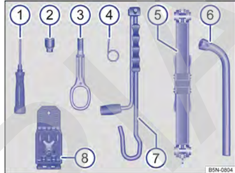
Fig. 207 Piezas de las herramientas de a bordo.
