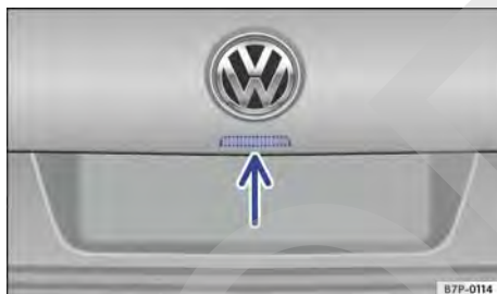
Fig. 73 En el portón del maletero: pulsador para abrir el portón.
