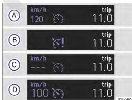
Fig. 143 En la pantalla del cuadro de instrumentos: indicaciones del estado del GRA (representación esquemática).
