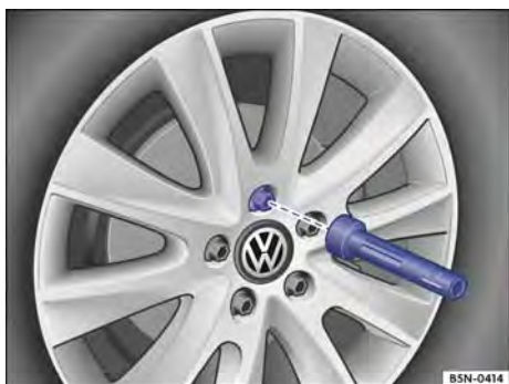
Fig. 257 Cambio de rueda: desenroscar los tornillos de rueda con el mango del destornillador.
