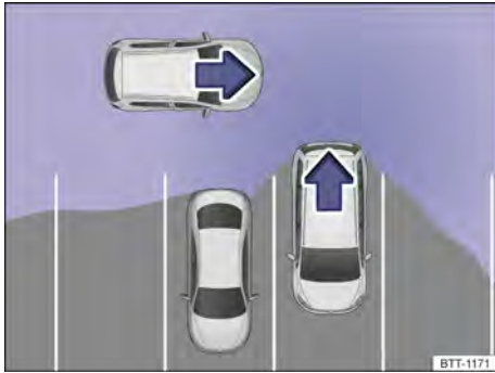
Fig. 165 Representación esquemática del asistente de salida del aparcamiento: zona vigilada alrededor del vehículo que está desaparcando.
