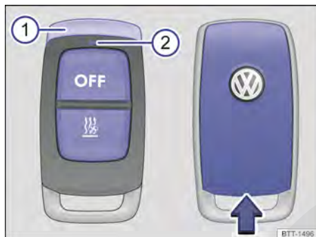
Fig. 117 Calefacción independiente: mando a distancia por radiofrecuencia (izq.) con compartimento para la batería (dcha.).
