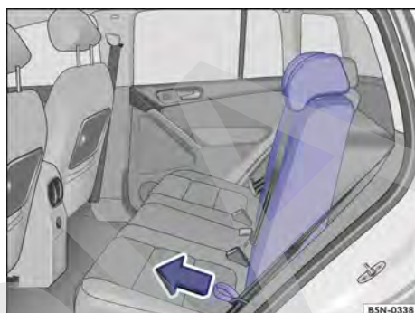
Fig. 88 Abatir y levantar el respaldo del asiento trasero.
