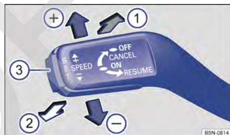
Fig. 140 En el lado izquierdo de la columna de dirección: palanca del GRA.
