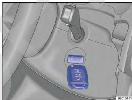
Fig. 125 En el lado derecho de la columna de dirección: función de arranque de emergencia en vehículos con el sistema de cierre y arranque sin llave Keyless Access.
