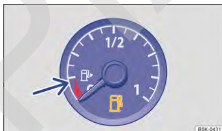
Fig. 19 Indicador del nivel de combustible en el cuadro de instrumentos analógico.
