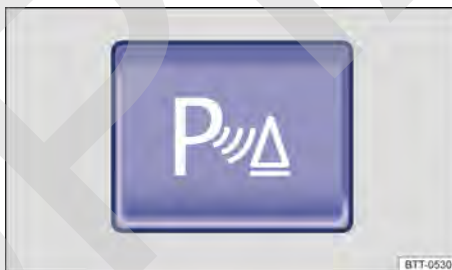
Fig. 156 En la consola central: tecla para conectar y desconectar la ayuda de aparcamiento (en función del equipamiento).
