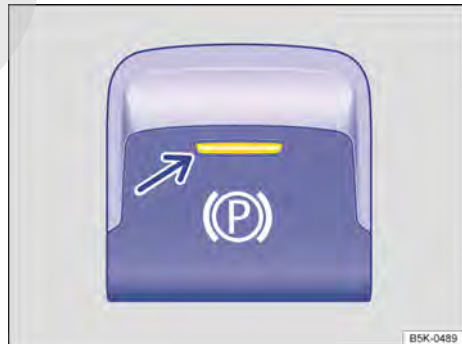
Fig. 154 En la consola central: tecla del freno de estacionamiento electrónico. ▶
