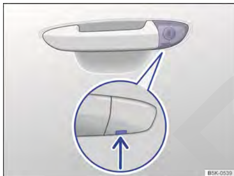
Fig. 70 Manilla de la puerta del conductor: bombín de la cerradura oculto.
