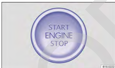
Fig. 124 En la parte inferior de la consola central: pulsador de encendido y arranque para poner el motor en marcha.
