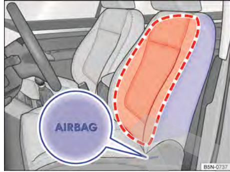
Fig. 49 Lateral de un asiento delantero: ubicación y zona de despliegue del airbag lateral.
