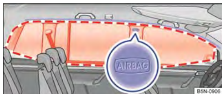
Fig. 51 En el lado izquierdo del vehículo (7 plazas): ubicación y zona de despliegue del airbag para la cabeza.
