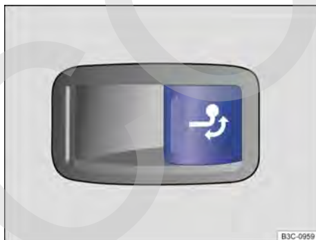
Fig. 200 En el lado derecho del maletero: tecla para desbloquear el enganche de bola.
