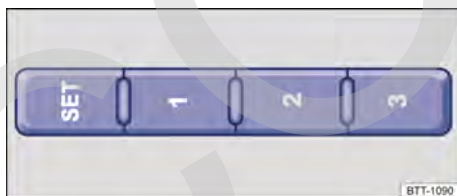
Fig. 96 En el lateral exterior del asiento del conductor: teclas de memoria.
