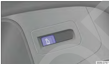
Fig. 66 En la puerta del conductor: desbloqueo del portón del maletero.
