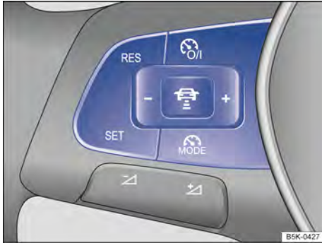
Fig. 150 Lado izquierdo del volante multifunción: teclas para manejar el ACC.
