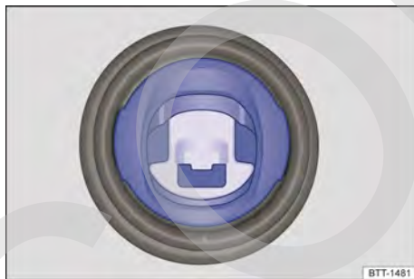
Fig. 204 En la boca de llenado del depósito de combustible: protección contra repostaje equivocado.
