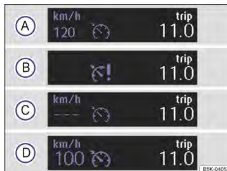
Fig. 141 En la pantalla del cuadro de instrumentos: indicaciones del estado del GRA (representación esquemática).
