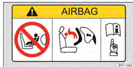
Fig. 55 Representación esquemática: etiqueta adhesiva relativa al airbag en el parasol.
