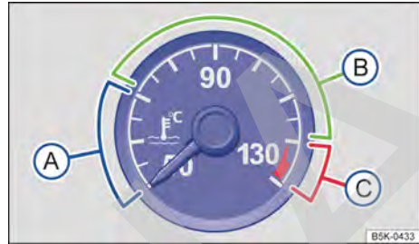
Fig. 21 Indicador de temperatura del líquido refrigerante del motor en el cuadro de instrumentos.
