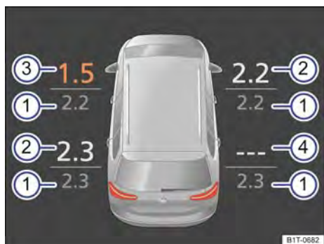
Fig. 243 Representación esquemática de la visualización en la pantalla del cuadro de instrumentos: presiones actuales de los neumáticos.
