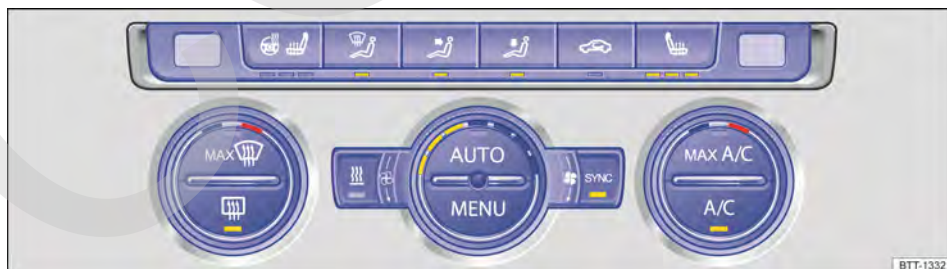
Fig. 115 En la parte superior de la consola central: mandos del Climatronic.
