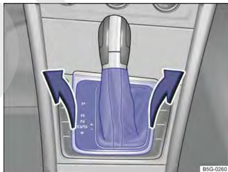
Fig. 131 Desmontar la cubierta de la corredera de la palanca selectora.
