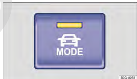
Fig. 133 En la parte inferior de la consola central: tecla de selección del perfil de conducción.
