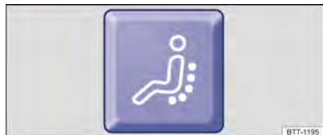
Fig. 100 En la parte inferior del asiento del conductor: tecla de la función de masaje.
