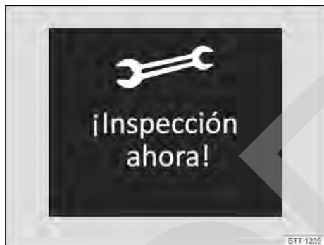
Fig. 23 En la pantalla del cuadro de instrumentos: ejemplo de visualización de un aviso de servicio (representación esquemática).
