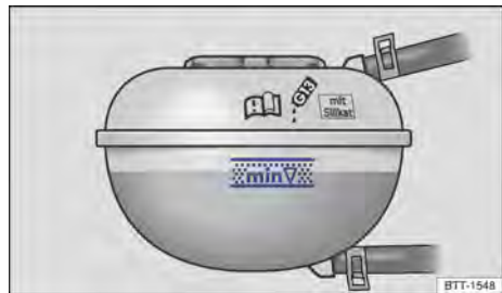
Fig. 238 En el vano motor: marcas en el depósito de expansión del líquido refrigerante del motor (representación esquemática).
