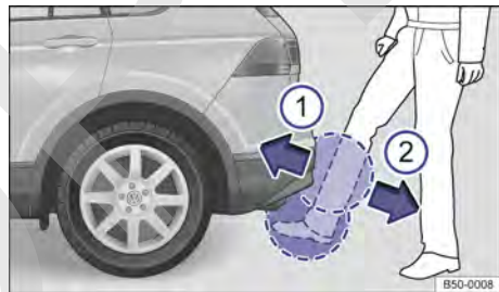
Fig. 75 Portón del maletero con apertura controlada por sensor (Easy Open).
