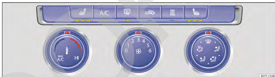
Fig. 114 En la parte superior de la consola central: mandos del climatizador manual.
