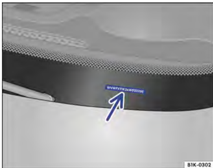
Fig. 263 En el parabrisas: número de identificación del vehículo.
