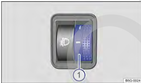
Fig. 105 Junto al volante: regulador del alcance de las luces ①.
