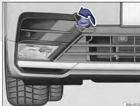
Fig. 231 En el lado derecho del paragolpes delantero: enroscar la argolla de remolque.
