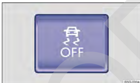
Fig. 167 En la consola central: tecla para desconectar y conectar manualmente el ASR.
