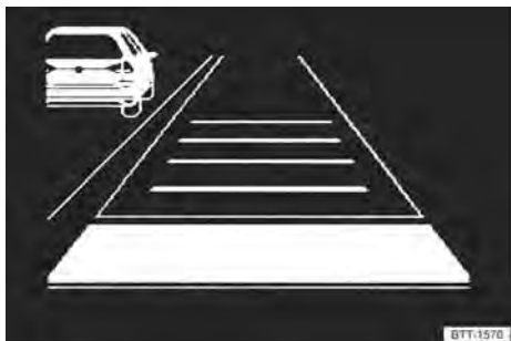
Fig. 147 En la pantalla del cuadro de instrumentos: vehículo detectado que circula más lentamente que el propio por el carril izquierdo (representación esquemática).
