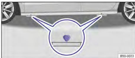
Fig. 255 Puntos de apoyo para el gato. ▶
