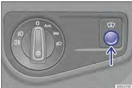
Fig. 15 Junto al volante: regulador del Head-up-Display (flecha).
