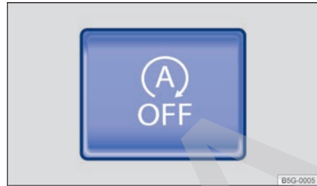
Fig. 108 En la parte inferior de la consola central: tecla del sistema Start-Stop.
