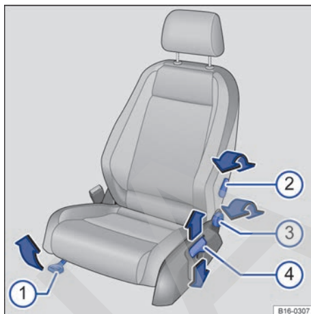
Fig. 69 En el asiento delantero izquierdo: mandos (variante 2).
