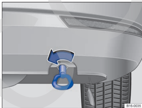
Fig. 191 En el lado derecho del paragolpes trasero: enroscar la argolla de remolque.
