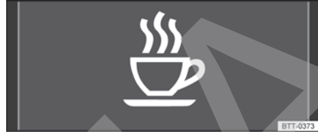
Fig. 12 En la pantalla del cuadro de instrumentos: símbolo de detección del cansancio.
