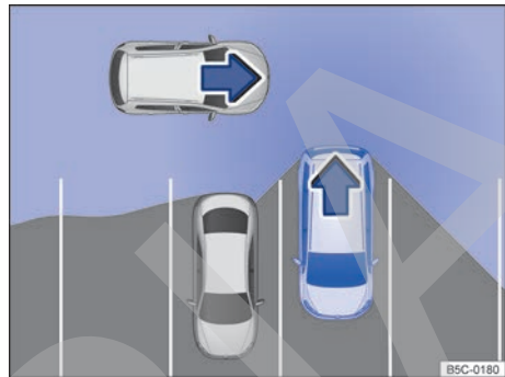
Fig. 131 Asistente de salida del aparcamiento: zona vigilada alrededor del vehículo que está desaparcando (representación esquemática).
