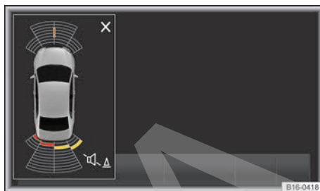
Fig. 136 Visualización periférica reducida del ParkPilot en la pantalla (a color) (representación esquemática).
