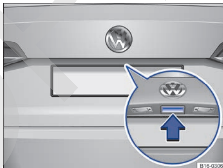
Fig. 58 Apertura del portón del maletero desde el exterior.
