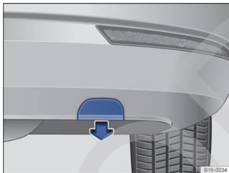
Fig. 190 En el lado derecho del paragolpes trasero: retirar la tapa.
