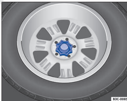
Fig. 211 En el maletero: ruedecilla para fijar la rueda de repuesto. ▶
