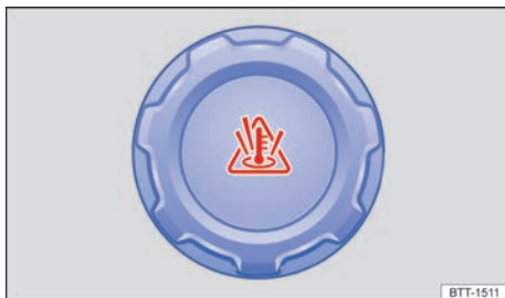
Fig. 202 En el vano motor: tapa del depósito de expansión del líquido refrigerante del motor (representación esquemática).
