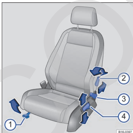
Fig. 68 En el asiento delantero izquierdo: mandos (variante 1).
