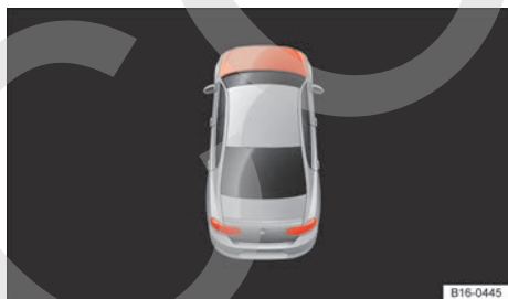
Fig. 197 En la pantalla del cuadro de instrumentos: capó del motor abierto o no cerrado correctamente (variante 2).
