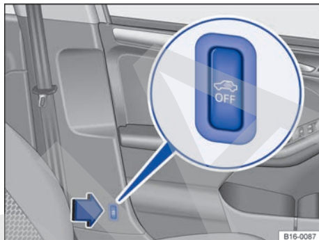
Fig. 51 Junto al asiento del conductor: tecla para desconectar la vigilancia del habitáculo y el sistema antirremolcado.
