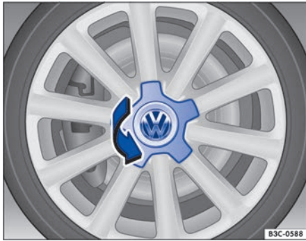
Fig. 214 Desmontar el tapacubos central girándolo.
