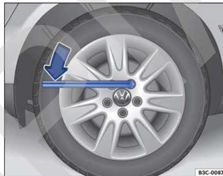
Fig. 217 Cambio de rueda: aflojar los tornillos de rueda.
