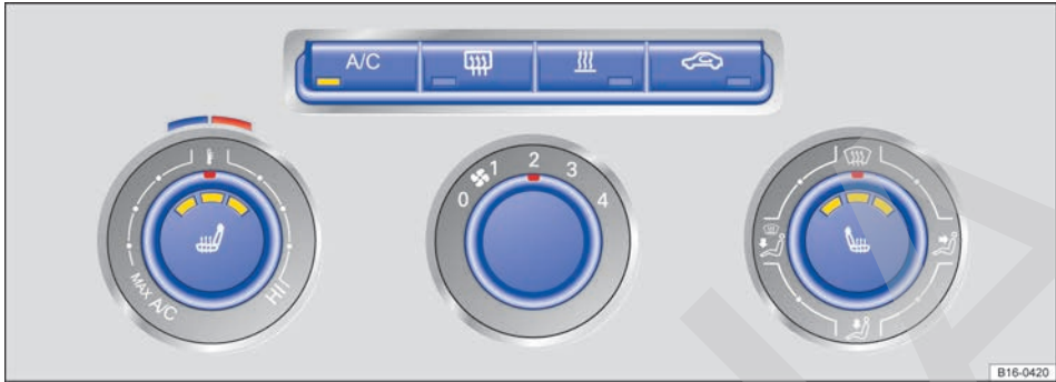
Fig. 94 En la parte superior de la consola central: mandos del climatizador manual (variante 1).
