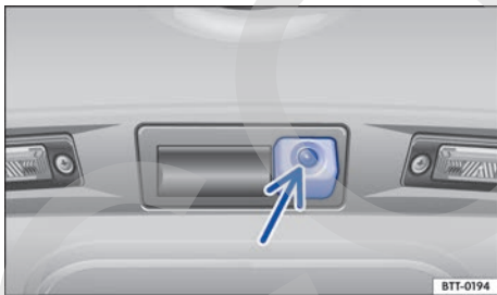
Fig. 142 En el portón del maletero: ubicación de la cámara del asistente de marcha atrás.
