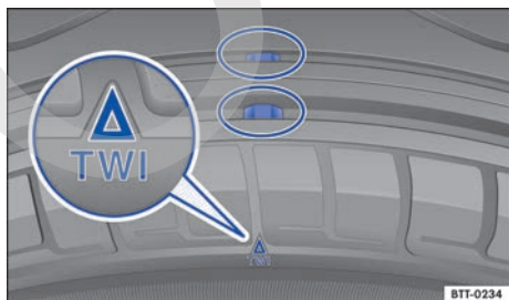
Fig. 210 Perfil del neumático: indicadores de desgaste.
