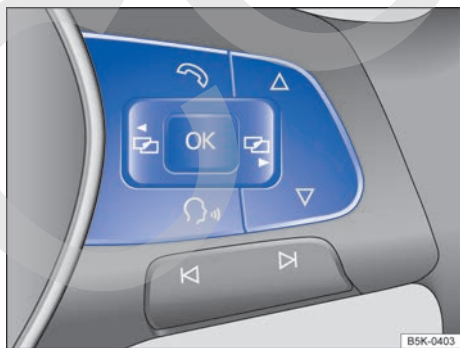
Fig. 17 Lado derecho del volante multifunción: teclas para utilizar los menús y las indicaciones informativas del cuadro de instrumentos.
