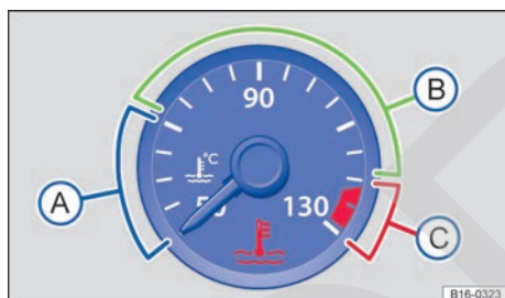
Fig. 15 En el cuadro de instrumentos: indicador de temperatura del líquido refrigerante del motor (representación esquemática).
