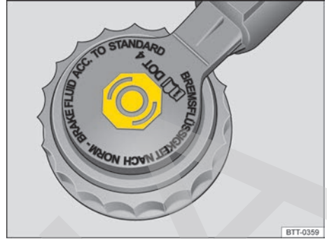
Fig. 203 En el vano motor: tapa del depósito del líquido de frenos (representación esquemática).
