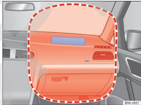
Fig. 32 Ubicación y zona de despliegue del airbag frontal del acompañante.
