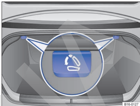
Fig. 72 En el maletero: palancas de desbloqueo de los respaldos del asiento trasero.
