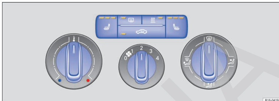
Fig. 97 En la parte superior de la consola central: mandos del sistema de calefacción y ventilación.
