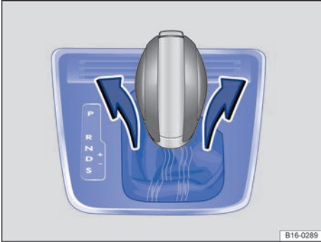
Fig. 114 Desmontar la cubierta de la corredera de la palanca selectora.
