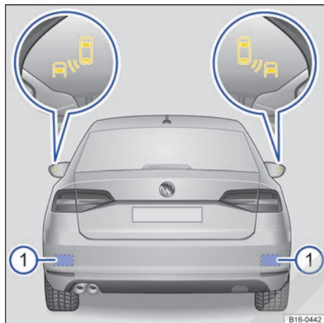
Fig. 128 Vista trasera del vehículo: zonas de los sensores de radar e indicaciones del detector de ángulo muerto.
