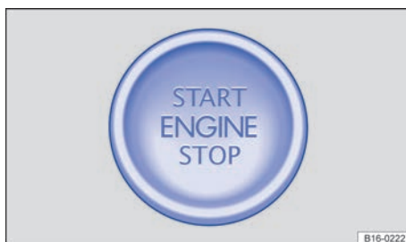
Fig. 105 En la parte inferior de la consola central: pulsador de encendido y arranque para poner el motor en marcha. ▶
