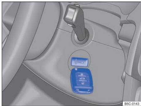
Fig. 106 En el lado derecho de la columna de dirección: función de arranque de emergencia en vehículos con el sistema de cierre y arranque sin llave Keyless Access.
