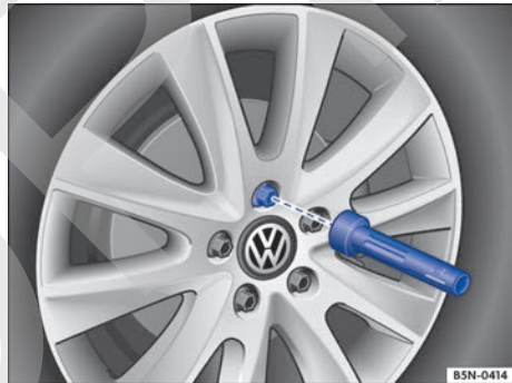
Fig. 191 Cambio de rueda: desenroscar los tornillos de rueda con el mango del destornillador.
