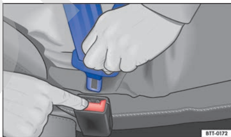
Fig. 28 Soltar la lengüeta del cierre del cinturón.
