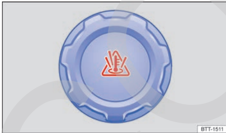
Fig. 171 En el vano motor: tapa del depósito de expansión del líquido refrigerante del motor (representación esquemática).
