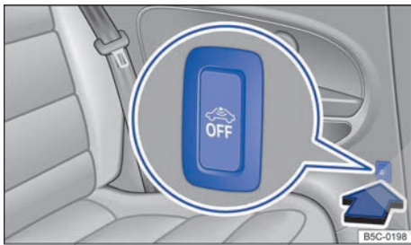
Fig. 52 Junto al asiento del conductor: tecla para desconectar la vigilancia del habitáculo y el sistema antirremolcado.
