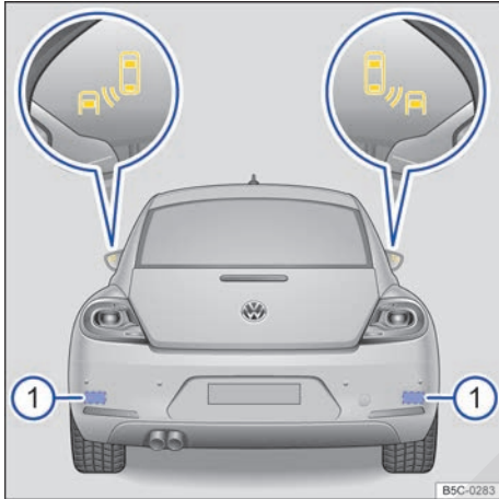
Fig. 108 Vista trasera del vehículo: zonas de los sensores de radar e indicaciones del detector de ángulo muerto.
