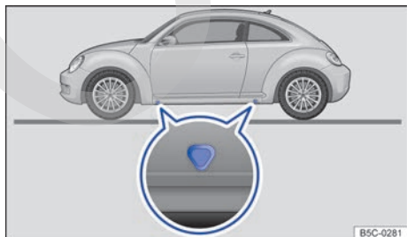
Fig. 189 Puntos de apoyo para el gato.
