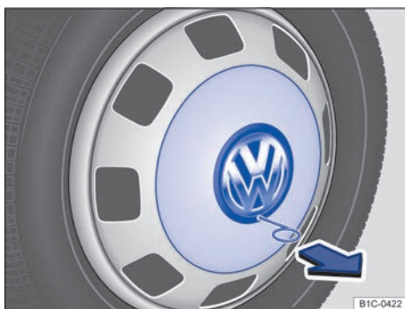
Fig. 185 Desmontar el tapacubos integral (variante 2)
