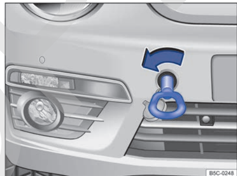
Fig. 162 En el lado derecho del paragolpes delantero: enroscar la argolla de remolque.
