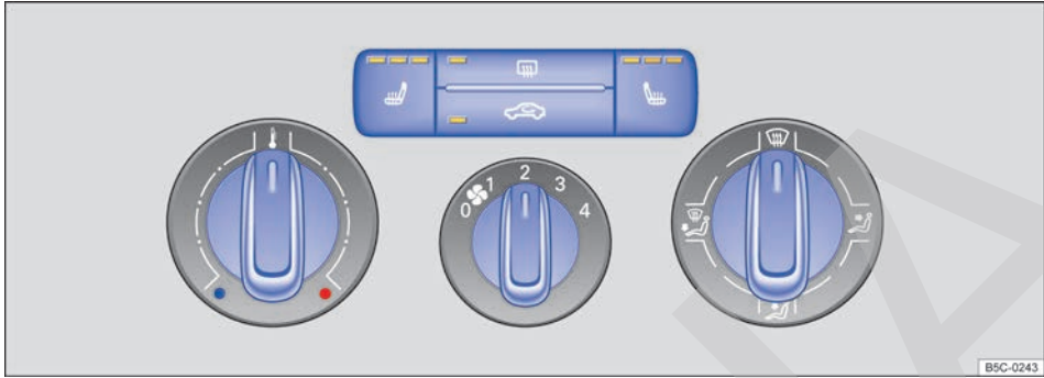
Fig. 89 En la parte superior de la consola central: mandos del sistema de calefacción y ventilación.
