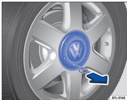
Fig. 182 Desmontar el tapacubos central tirando de él.
