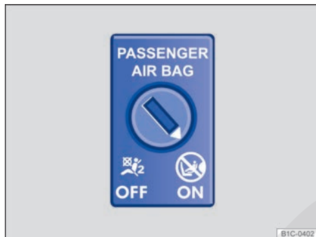
Fig. 34 En el lateral del tablero de instrumentos del lado del acompañante: conmutador de llave para activar y desactivar el airbag frontal del acompañante.
