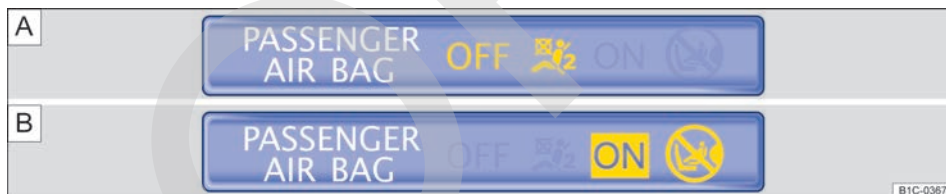
Fig. 31 Testigo de control en la parte superior de la consola central: A ) Airbag frontal del acompañante desactivado; B ) Airbag frontal del acompañante activado.
