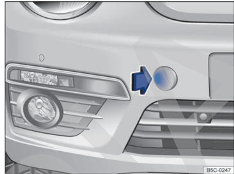
Fig. 161 En el lado derecho del paragolpes delantero: retirar la tapa.
