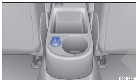
Fig. 132 Toma de corriente de 12 voltios en la parte trasera de la consola central.
