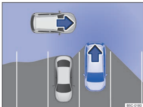
Fig. 111 Representación esquemática del asistente de salida del aparcamiento: zona vigilada alrededor del vehículo que está desapareando.
