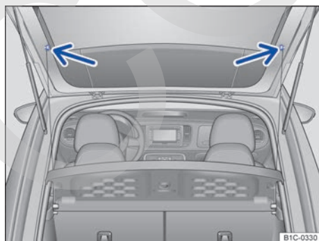
Fig. 136 En el maletero: enganchar y desenganchar las cintas de sujeción de la cubierta en el portón del maletero.
