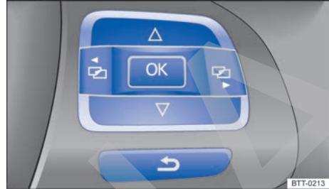
Fig. 18 Lado derecho del volante multifunción: teclas para utilizar los menús y las indicaciones informativas del cuadro de instrumentos.
