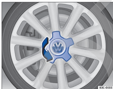
Fig. 183 Desmontar el tapacubos central girándolo.
