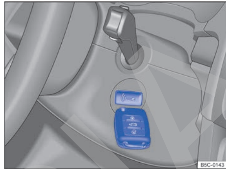
Fig. 98 En el lado derecho de la columna de dirección: función de arranque de emergencia.
