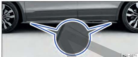
Fig. 269 Puntos de apoyo para el gato (representación esquemática).
