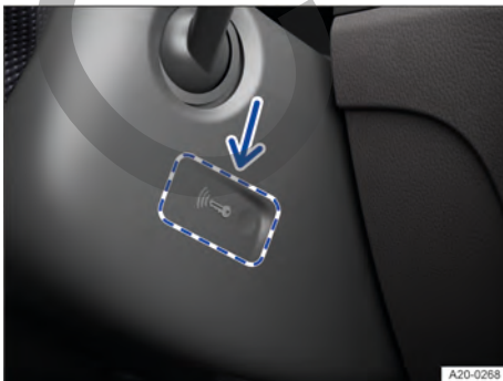
Fig. 140 En el lado derecho de la columna de dirección: función de arranque de emergencia en los vehículos con el sistema de cierre y arranque sin llave "Keyless Access".
