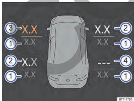
Fig. 261 Representación esquemática de la visualización en la pantalla del cuadro de instrumentos: presiones actuales de los neumáticos.
