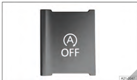
Fig. 141 En la parte inferior de la consola central o, en función del equipamiento, en el sistema de infotainment: tecla del sistema Start-Stop.
