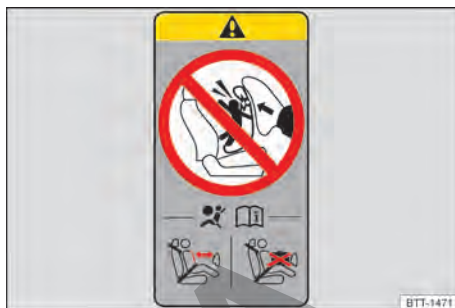
Fig. 54 Representación esquemática: etiqueta adhesiva relativa al airbag en el pilar B.
