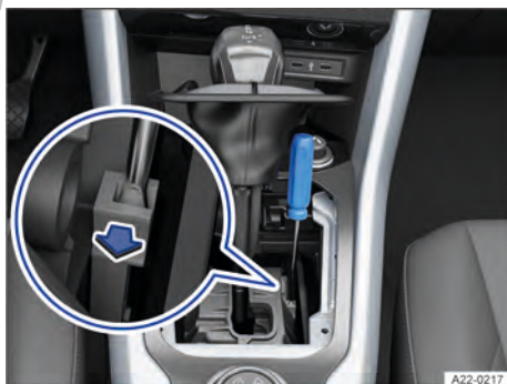
Fig. 146 Realizar un desbloqueo de emergencia de la palanca selectora (variante 2).
