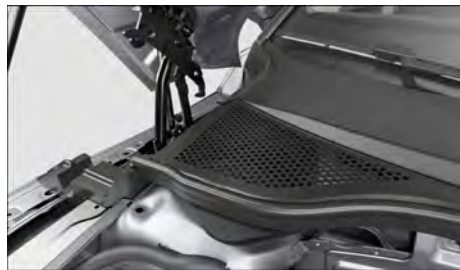
Fig. 277 Entre el vano motor y el parabrisas: caja de aguas (representación esquemática).
