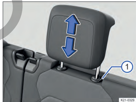
Fig. 100 Representación esquemática: ajuste de los apoyacabezas de la segunda fila de asientos.
