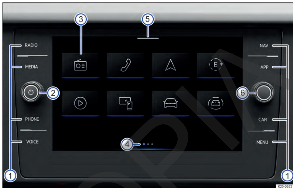
Fig. 194 Cuadro general: unidad de mandos e indicación en la versión de 8 pulgadas.
