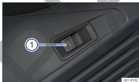
Fig. 78 En la puerta del conductor: tecla de desbloqueo del portón trasero.
