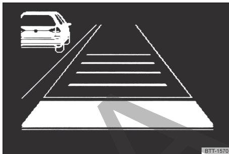
Fig. 158 En la pantalla del cuadro de instrumentos: vehículo detectado que circula más lentamente que el propio por el carril izquierdo (representación esquemática).
