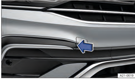
Fig. 239 En el lado derecho del paragolpes delantero: retirar la tapa.
