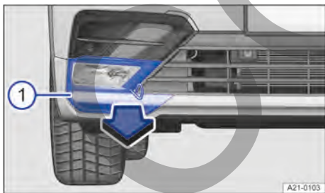
Fig. 227 R-Line en el lado derecho del paragolpes delantero: faro antiniebla.
