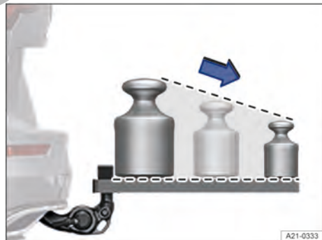
Fig. 212 Reparto recomendado del peso en el sistema portante trasero.
