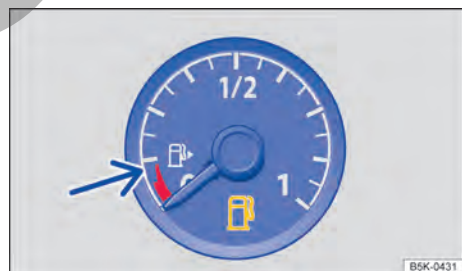
Fig. 24 Indicador del nivel de combustible en el cuadro de instrumentos analógico (representación esquemática).
