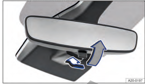
Fig. 123 En el parabrisas: retrovisor interior antideslumbrante manual.
