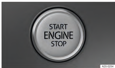
Fig. 139 En la parte inferior de la consola central: pulsador de encendido y arranque para poner el motor en marcha.
