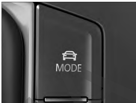
Fig. 147 En la consola central: tecla MODE para seleccionar los perfiles de conducción.
