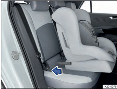
Fig. 55 Representación esquemática: montaje de un asiento para niños con conectores.
