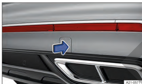
Fig. 242 En el lado derecho del paragolpes trasero: retirar la tapa, variante 2.
