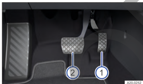
Fig. 134 En la zona reposapiés: pedales en los vehículos con cambio automático.
