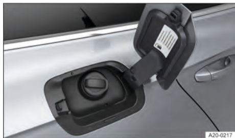
Fig. 218 Detrás de la tapa del depósito de combustible: tapón del depósito (representación esquemática).
