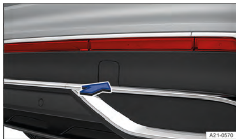
Fig. 241 En el lado derecho del paragolpes trasero: retirar la tapa, variante 1.
