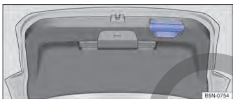
Fig. 77 En el portón trasero abierto: asidero para cerrar el portón.
