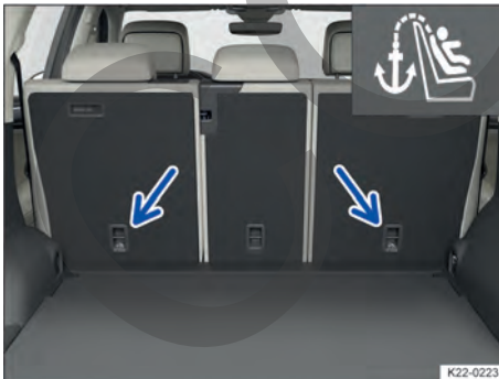
Fig. 56 En la parte posterior del asiento trasero: anclajes Top Tether para el cinturón de fijación superior Top Tether.
