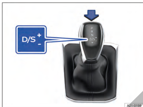
Fig. 143 Palanca selectora del cambio automático con tecla de bloqueo (flecha).
