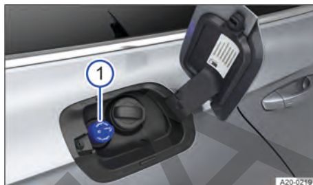
Fig. 219 Detrás de la tapa del depósito de combustible: tapón del depósito de AdBlue (representación esquemática).
