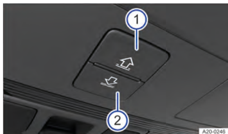
Fig. 126 En el revestimiento interior del techo: teclas para manejar la cortinilla parasol.
