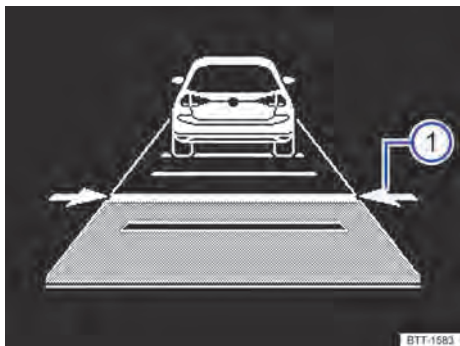
Fig. 165 En la pantalla del cuadro de instrumentos: distancia ajustada ① (representación esquemática, el ACC regula).
