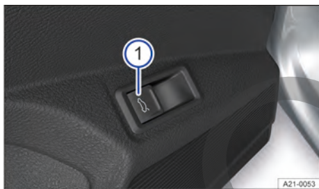
Fig. 71 En la puerta del conductor: tecla para la apertura eléctrica del portón trasero (representación esquemática).
