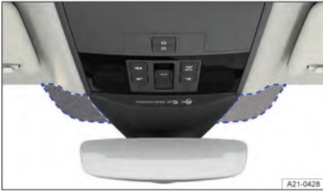
Fig. 127 Junto a la base del retrovisor: ventana de comunicación (representación esquemática).
