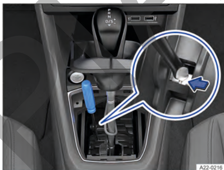
Fig. 145 Realizar un desbloqueo de emergencia de la palanca selectora (variante 1).
