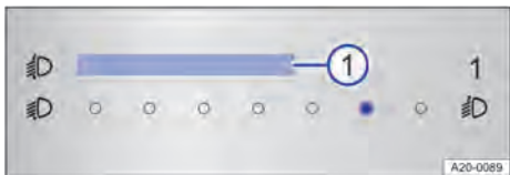
Fig. 118 En el sistema de infotainment: regulador táctil para la regulación del alcance de las luces.
