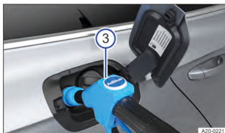
Fig. 221 Detrás de la tapa del depósito de combustible: repostar AdBlue con la pistola de un surtidor (representación esquemática).
