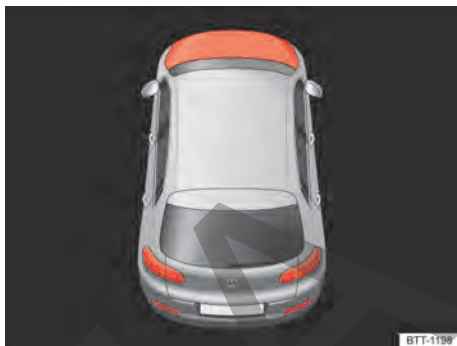
Fig. 247 En la pantalla del cuadro de instrumentos: capó delantero abierto o no cerrado correctamente (representación esquemática).
