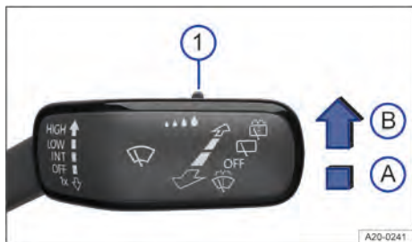
Fig. 121 En el lado derecho de la columna de dirección: palanca del limpiacristales.
