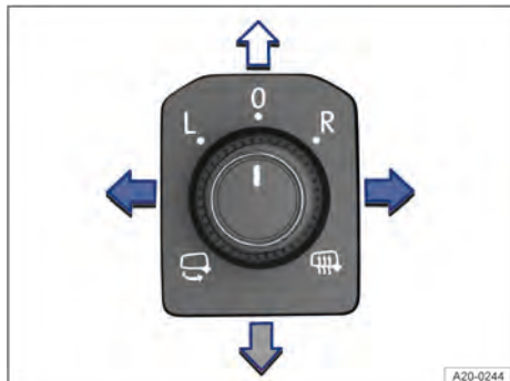
Fig. 124 En la puerta del conductor: mando giratorio de los retrovisores exteriores.
