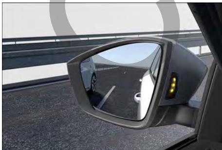
Fig. 170 En la carcasa de los retrovisores exteriores: indicaciones ópticas del asistente de cambio de carril.
