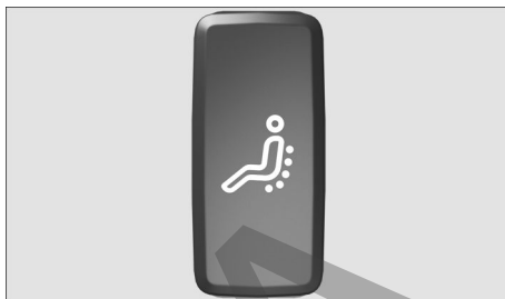
Fig. 112 En la parte inferior del asiento del conductor: tecla de la función de masaje.
