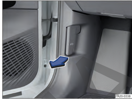
Fig. 245 En la zona reposapiés del lado del conductor: palanca de desbloqueo del capó delantero (representación esquemática).
