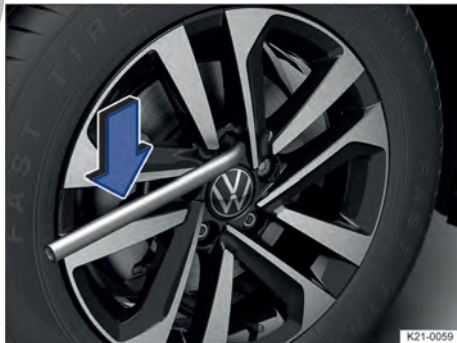
Fig. 264 Cambio de rueda: aflojar los tornillos de rueda.
