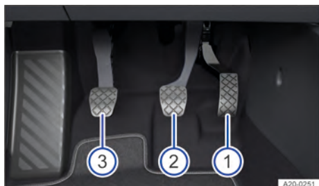
Fig. 133 En la zona reposapiés: pedales en los vehículos con cambio manual.
