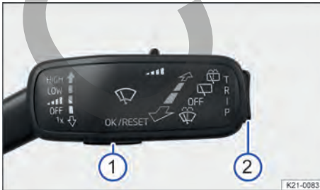
Fig. 17 En el lado derecho de la columna de dirección: teclas de la palanca del limpiacristales.
