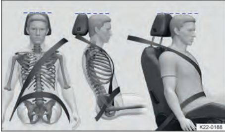
Fig. 38 Colocación correcta de la banda del cinturón y ajuste correcto del apoyacabezas.
