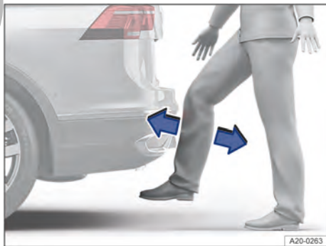
Fig. 80 Representación esquemática del portón del maletero con apertura controlada por sensor (Easy Open).
