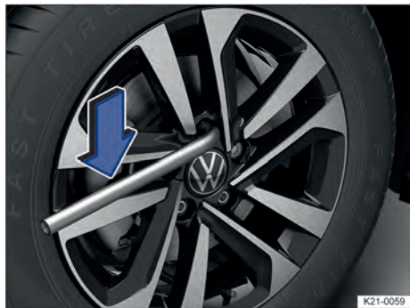
Fig. 272 Cambio de rueda: desenroscar los tornillos de rueda con la llave de rueda.
