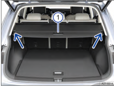
Fig. 197 En el maletero: abrir la cubierta del maletero (representación esquemática).
