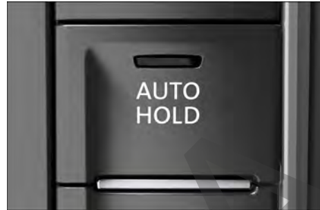
Fig. 172 En la consola central: tecla de la función Auto Hold.
