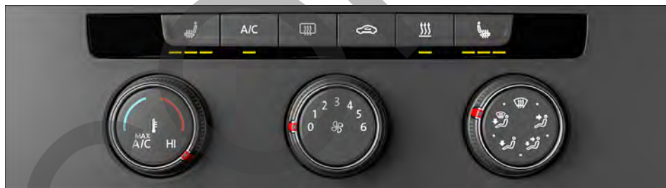
Fig. 130 En la parte superior de la consola central: panel de mandos del climatizador manual.
