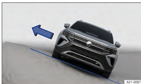
Fig. 153 Representación esquemática: bajar del vehículo siempre por el lado que mira a la cima.
