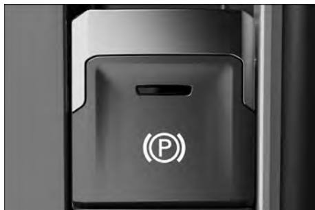
Fig. 171 En la consola central: tecla del freno de estacionamiento electrónico.
