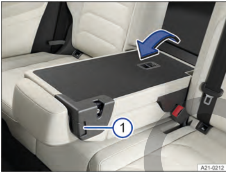
Fig. 208 En el respaldo del asiento trasero: apertura de la trampilla para cargas largas.
