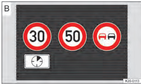
Fig. 32 En la pantalla del cuadro de instrumentos: ejemplos de visualización de señales de tráfico.
