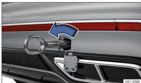
Fig. 244 En el lado derecho del paragolpes trasero: enroskar la argolla de remolque, variante 2.
