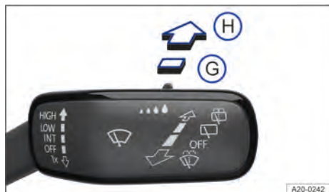
Fig. 120 En el lado derecho de la columna de dirección: manejo del limpiacristales.
