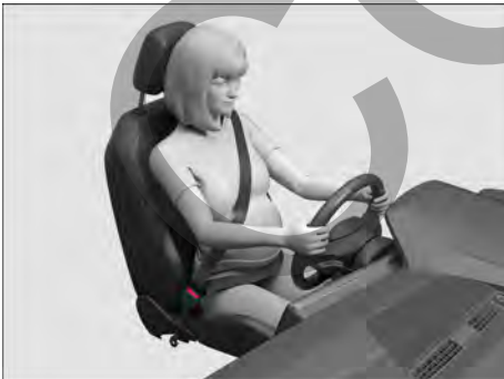
Fig. 39 Colocación correcta de la banda del cinturón en las mujeres embarazadas.
