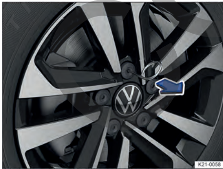
Fig. 263 Retirar las caperezas de los tornillos de rueda.
