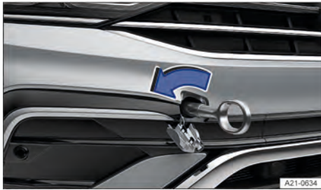
Fig. 240 En el lado derecho del paragolpes delantero: enroskar la argolla de remolque.
