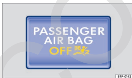
Fig. 29 En la parte superior de la consola central: testigo de control de la desactivación del airbag frontal del acompañante.
