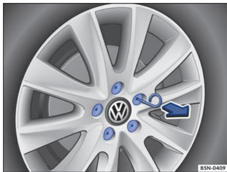
Fig. 175 Retirar las caperuzas de los tornillos de rueda.
