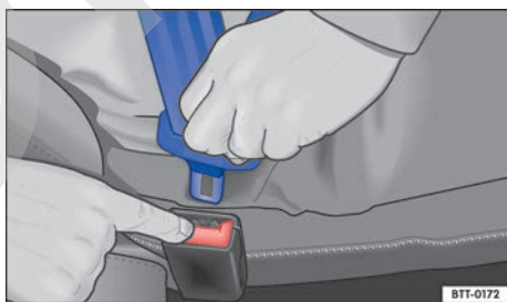
Fig. 26 Soltar la lengüeta del cierre del cinturón.
