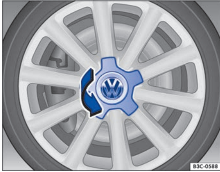
Fig. 173 Desmontar el tapacubos central girándolo.
