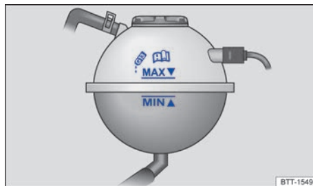
Fig. 160 En el vano motor: marcas en el depósito de expansión del líquido refrigerante del motor (representación esquemática).
