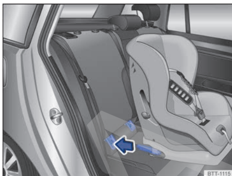
Fig. 40 Representación esquemática: montaje de un asiento para niños ISOFIX con conectores.
