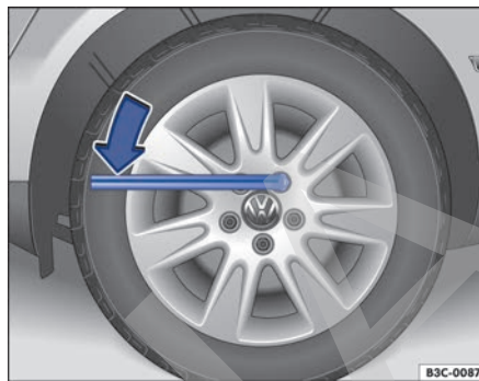
Fig. 176 Cambio de rueda: aflojar los tornillos de rueda.
