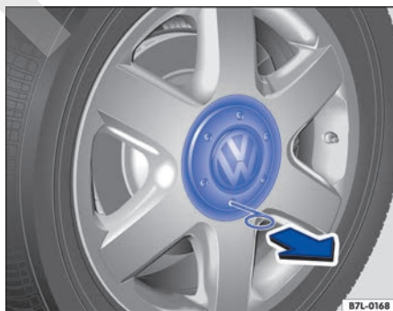
Fig. 172 Desmontar el tapacubos central tirando de él.
