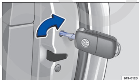
Fig. 55 En el frontal de la puerta del acompañante: bloqueo de emergencia de la puerta del acompañante con la llave del vehículo.
