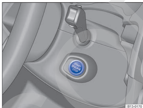
Fig. 91 En el lado derecho de la columna de dirección: pulsador de encendido y arranque para poner el motor en marcha.
