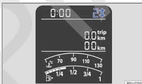
Fig. 92 En el panel de instrumentos : indicador de cambio de marcha (variante 1).
