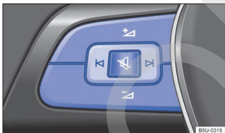
Fig. 44 Lado izquierdo del volante multifunción: teclas de comando.
