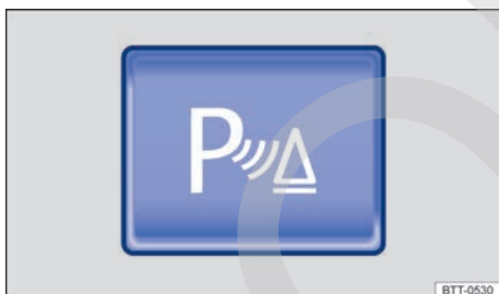
Fig. 104 En la parte superior de la consola central: pulsador para activar y desactivar el control de distancia de aparcamiento (Park Pilot).
