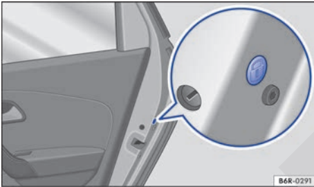
Fig. 55 En la parte delantera de la puerta derecha: bloqueo de emergencia, cubierto por una junta de goma.
