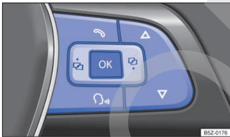
Fig. 43 Lado derecho del volante multifunción: teclas de mando de los menús del panel de instrumentos.
