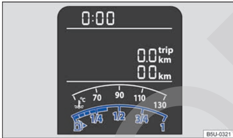
Fig. 37 En el display del instrumento combinado: indicador del nivel de combustible (variante 1).
