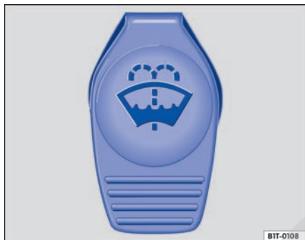
Fig. 168 En el compartimento del motor: tapa del tanque de agua de los lavaparabrisas.
