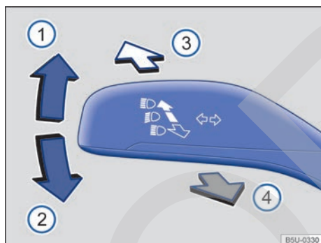
Fig. 75 Palanca de los indicadores de dirección y del faro alto / largo alcance en la posición básica.
