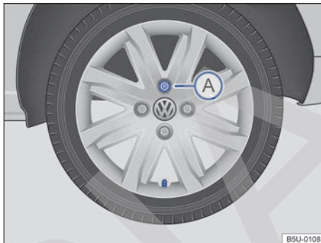
Fig. 184 Retirar la super llanta.
