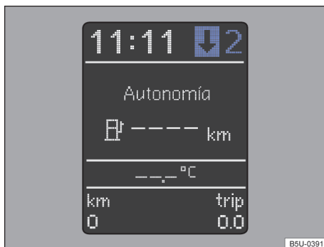
Fig. 93 En el panel de instrumentos : indicador de cambio de marcha (variante 2).
