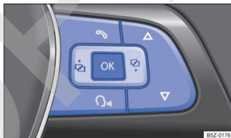
Fig. 45 Lado derecho del volante multifunción: teclas de comando.
