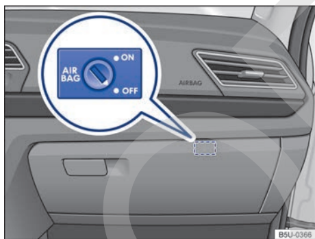
Fig. 18 En la guantera: interruptor desaccionado por la llave para apagar y encender el airbag frontal del pasajero.
