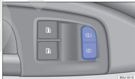
Fig. 52 En la puerta del conductor: teclas del cierre centralizado
