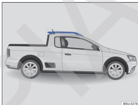
Fig. 136 Soportes longitudinales del portaequipajes de techo (ambos lados).
