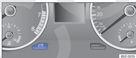
Fig. 61 En el panel de instrumentos: tecla de regulación de la iluminación de los instrumentos y de los interruptores.
