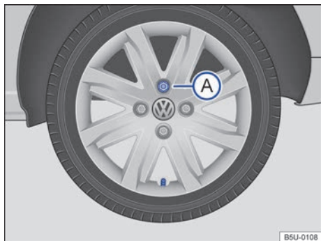
Fig. 141 Cambio de rueda: secuencia de desmontaje de los tornillos de la rueda.
