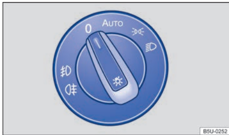
Fig. 60 En el panel: conmutador de las luces.
