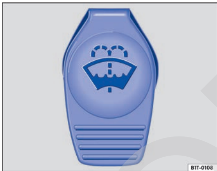
Fig. 68 En el compartimento del motor: tapa del tanque de agua de los lavaparabrisas.
