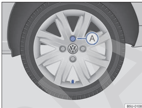
Fig. 138 Retirar la superllanta.
