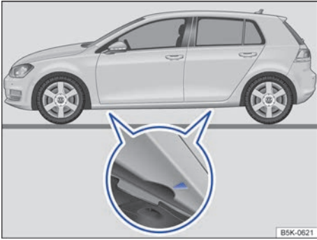
Fig. 229 Puntos de apoyo para el gato.
