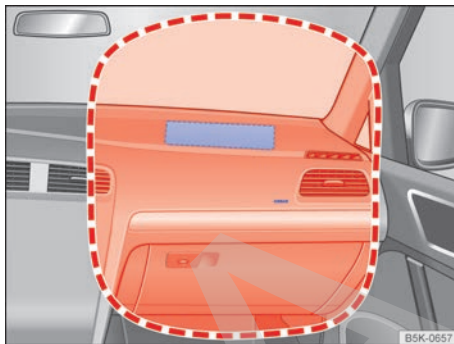
Fig. 16 Ubicación y zona de despliegue del airbag frontal del acompañante.
