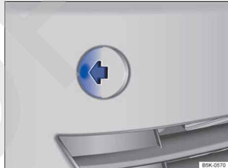
Fig. 201 En el lado derecho del paragolpes delantero: retirar la tapa.
