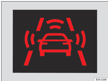
Fig. 137 En la pantalla del cuadro de instrumentos: indicación del preaviso.
