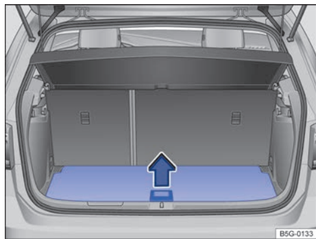
Fig. 174 En el maletero: levantar el piso variable.
