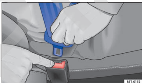
Fig. 10 Soltar la lengüeta del cinturón de seguridad de su cierre.
