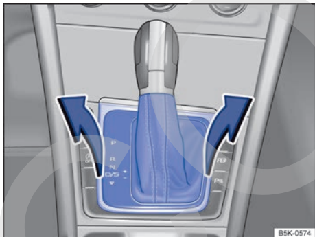
Fig. 75 Desmontar la cubierta de la corredera de la palanca selectora.
