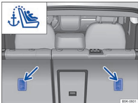
Fig. 27 Argollas de sujeción en la parte posterior del asiento trasero para fijar el cinturón de fijación superior.
