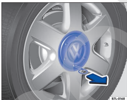
Fig. 221 Desmontar el tapacubos central tirando de él.
