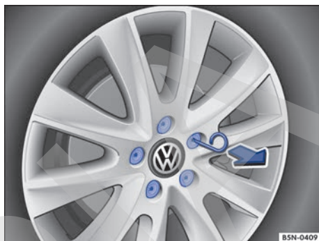
Fig. 224 Quitar los capuchones de los tornillos de rueda.
