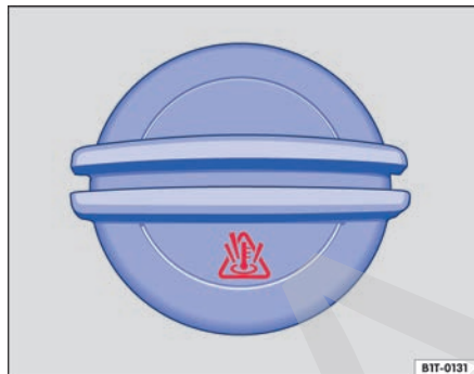
Fig. 212 En el vano motor: tapa del depósito de expansión del líquido refrigerante del motor.
