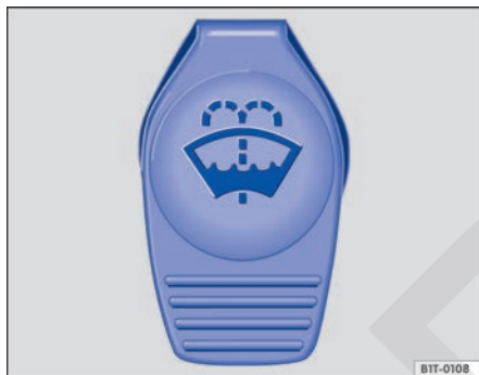
Fig. 100 En el vano motor: tapa del depósito del lavacristales.
