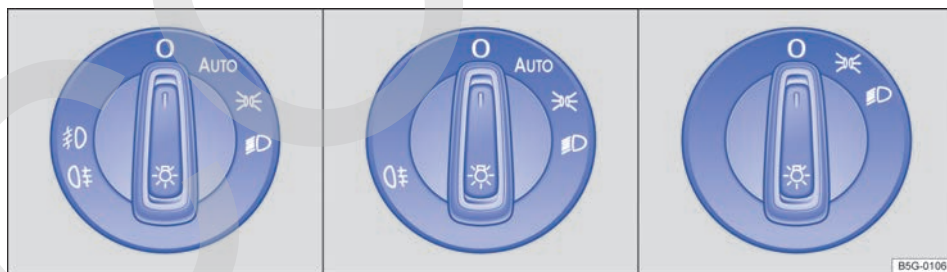
Fig. 89 Junto al volante: representación de algunos tipos de mandos de luces.
