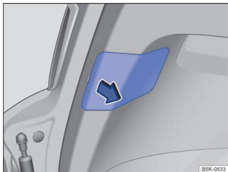
Fig. 187 En el portón del maletero: retirar la tapa.
