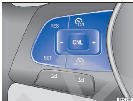
Fig. 129 Lado izquierdo del volante multifunción: teclas para manejar el limitador de velocidad.
