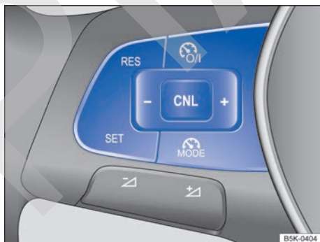
Fig. 126 Lado izquierdo del volante multifunción: teclas para manejar el GRA.
