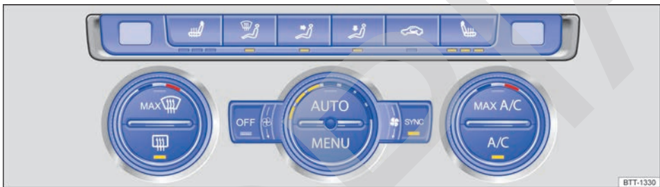
Fig. 107 En la parte superior de la consola central: mandos del Climatronic.
