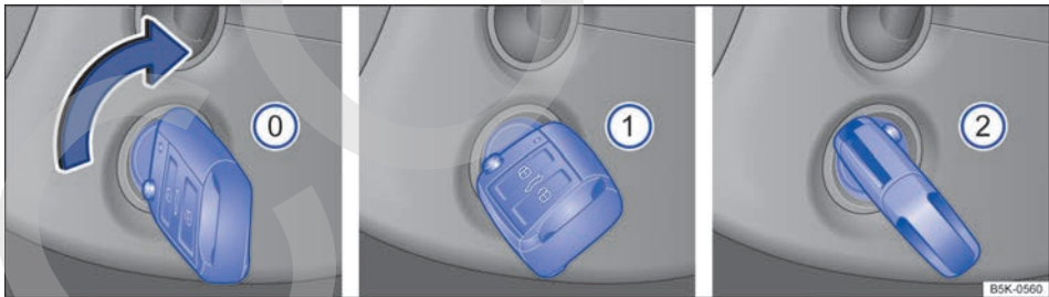
Fig. 114 Posiciones de la llave del vehículo en la cerradura de encendido.
