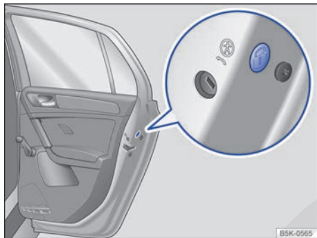
Fig. 71 En el frontal de la puerta trasera derecha: bloqueo de emergencia cubierto por una junta de goma.
