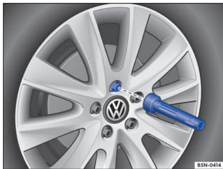
Fig. 233 Cambio de rueda: desenroscar los tornillos de rueda con el mango del destornillador.
