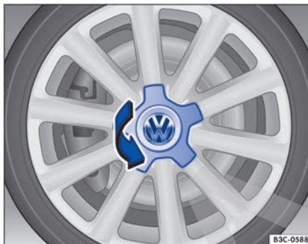
Fig. 222 Desmontar el tapacubos central girándolo.
