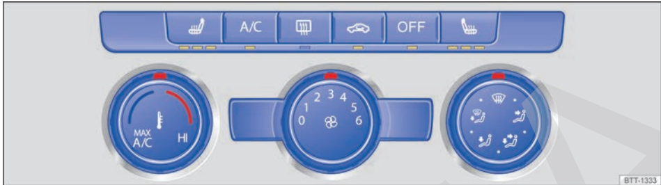
Fig. 106 En la parte superior de la consola central: mandos del climatizador manual.
