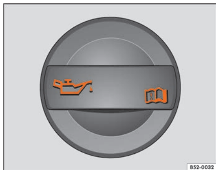
Fig. 210 En el vano motor: tapa de la boca de llenado de aceite.
