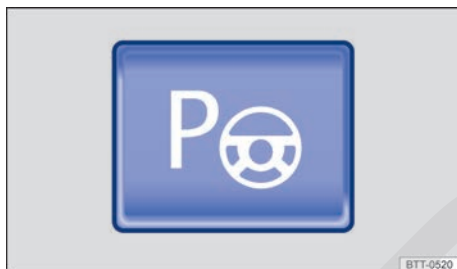
Fig. 148 En la parte inferior de la consola central: tecla para conectar el sistema de aparcamiento asistido.
