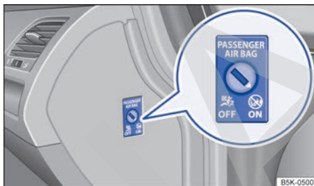
Fig. 17 En el tablero de instrumentos del lado del acompañante: conmutador de llave para activar y desactivar el airbag frontal del acompañante.
