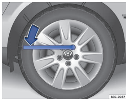
Fig. 225 Cambio de rueda: aflojar los tornillos de rueda.
