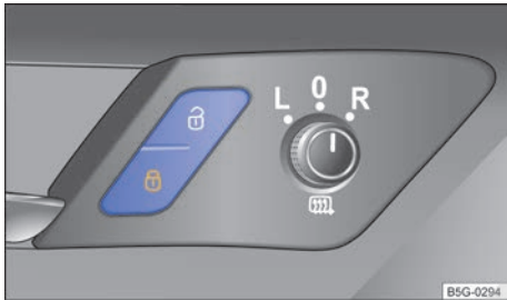
Fig. 58 En la puerta del conductor: tecla del cierre centralizado.
