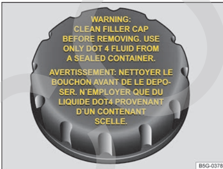
Fig. 208 En el vano motor: tapa del depósito del líquido de frenos (variante 2).
