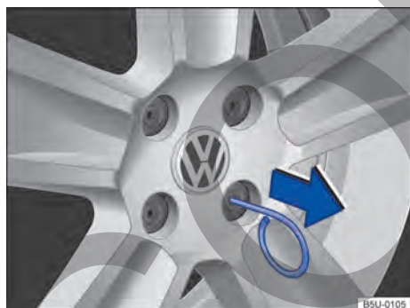
Fig. 219 Retirar las caperuzas de los tornillos de rueda.
