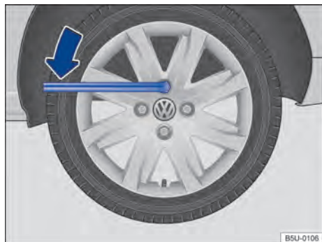
Fig. 221 Cambio de rueda: aflojar los tornillos de la rueda.
