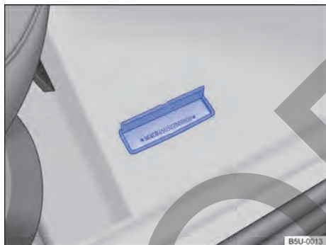
Fig. 228 Frente al asiento del pasajero: número de identificación del vehículo (número del chasis) en el piso, frente al asiento del acompañante.
