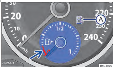
Fig. 13 En el instrumento combinado: indicador del nivel de combustible (variante 2).
