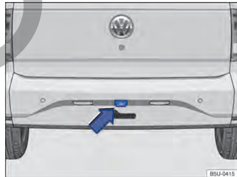
Fig. 95 En el paragolpes trasero: lugar de instalación del asistente de conducción en marcha atrás.
