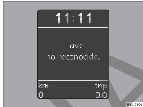
Fig. 85 En el panel de instrumentos: display con indicación del inmovilizador activado - vehículos con Sistema de Informaciones Volkswagen.
