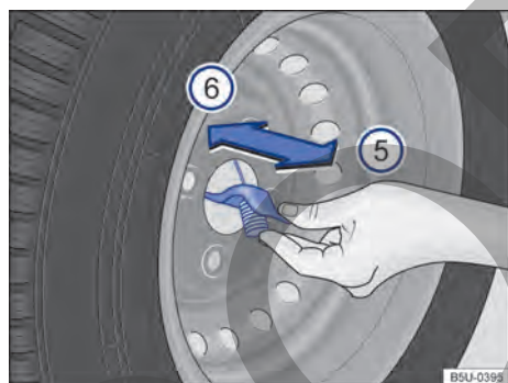
Fig. 217 En la rueda de emergencia: retirar el cable de la rueda de emergencia.
