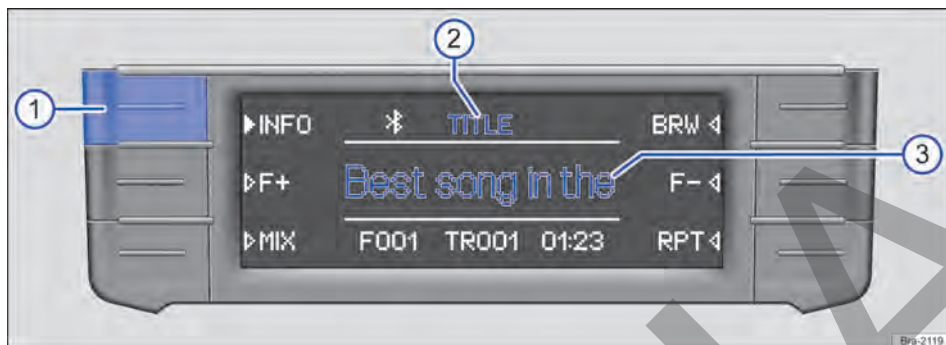
Fig. 159 Ejemplo de visualización en el modo Media: información de las pistas de un CD de MP3 que se está reproduciendo.
