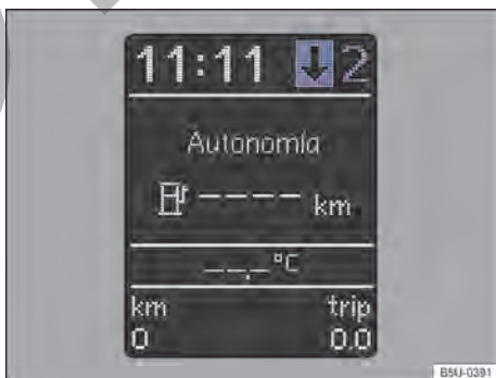
Fig. 82 En el panel de instrumentos : indicador de cambio de marcha (variante 2).
