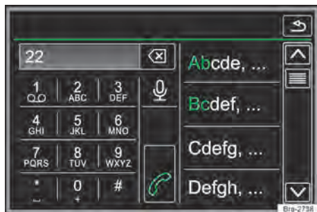
Fig. 144 Menú introducir número de teléfono (seleccionar contacto de la lista).
