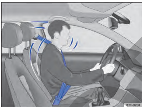
Fig. 26 Conductor protegido por el cinturón de seguridad correctamente colocado en una maniobra de frenado súbita.
