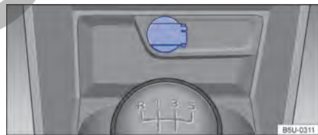
Fig. 116 En la consola central delantera: toma de corriente de 12 V.
