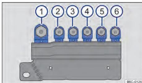
**Fig. 172** En el compartimento del motor encima de la batería: disposición de los fusibles.
