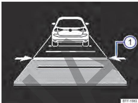
**Fig. 101** En el display del instrumento combinado: ajustar la distancia (representación esquemática, el ACC regula).
