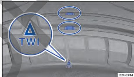
**Fig. 190** Perfil del neumático: indicadores de desgaste.
