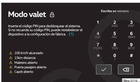
Fig. 153 Pantalla de bloqueo del modo de valet.
