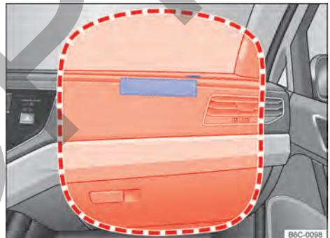
Fig. 34 Ubicación y radio de expansión del airbag frontal del acompañante.
