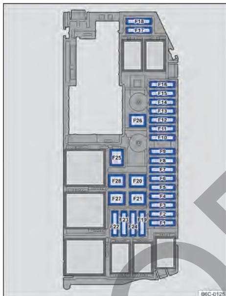
**Fig. 171** En el compartimento del motor: disposición de los fusibles.
