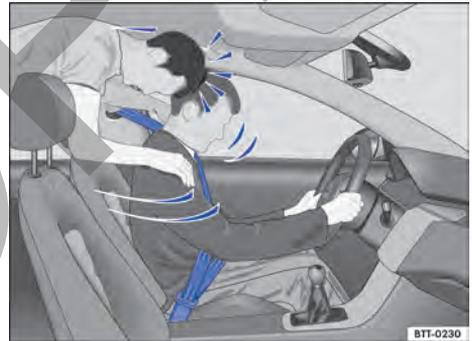
**Fig. 25** El pasajero sin cinturón de seguridad en el asiento trasero es lanzado hacia adelante sobre el conductor con cinturón de seguridad.
