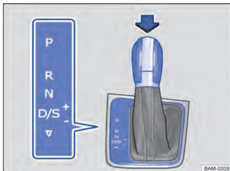
Fig. 89 Palanca selectora de la transmisión automática con tecla de bloqueo (flecha).
