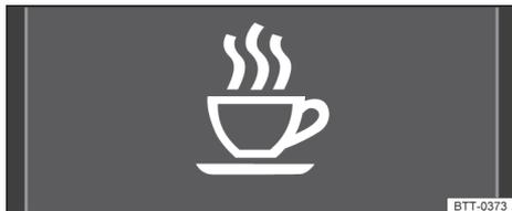
Fig. 15 En el display del instrumento combinado: símbolo del sistema de detección del cansancio.
