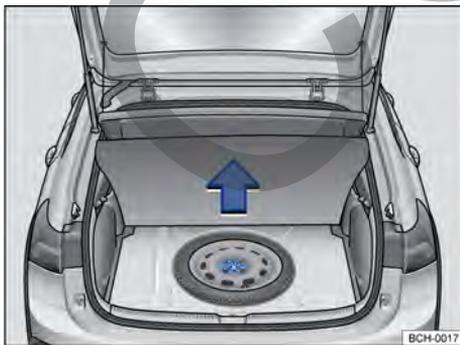
**Fig. 158** En el maletero, por debajo del revestimiento del piso: rueda de emergencia y herramientas de a bordo.
