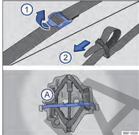
**Fig. 159** En el maletero: cinta de fijación de la caja de herramientas y caja de herramientas de a bordo.
