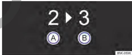
Fig. 83 En el instrumento combinado: indicador de cambio de marcha.
