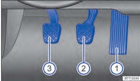
Fig. 81 En la zona reposapiés: pedales en vehículos con transmisión manual.
