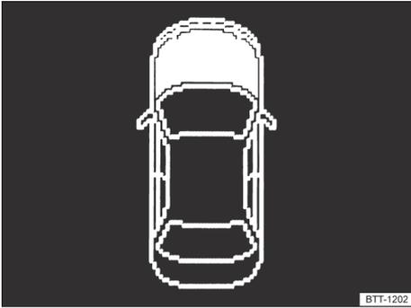
**Fig. 178** En el display del instrumento combinado: tapa del compartimento del motor abierta o cerrada incorrectamente (representación esquemática).
