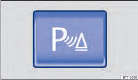
**Fig. 103** En la radio: encender y apagar la ayuda de aparcamiento.
