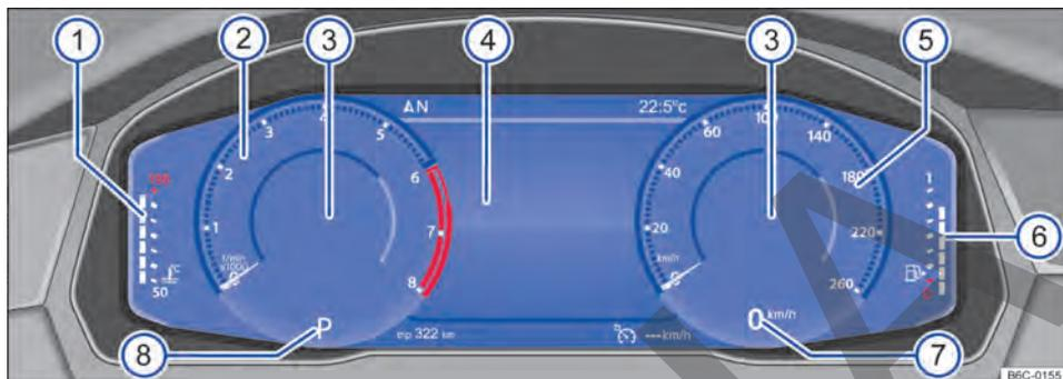
Fig. 9 Active Info Display (variante 1) en el tablero de instrumentos.
