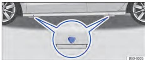
Fig. 194 Puntos de apoyo del gato.
