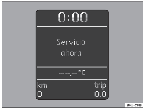
Fig. 16 Display del panel de instrumentos: indicador del intervalo de servicio.
