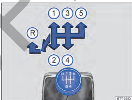
Fig. 80 Esquema de la transmisión manual de 5 marchas.
