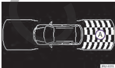
Fig. 88 Indicación del display del control de distancia de estacionamiento delantero y trasero en el radio (no disponible para algunas versiones).
