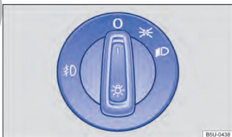
Fig. 61 Al lado del volante: interruptor de luces.
