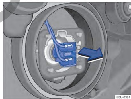
Fig. 152 Acceso a la bombilla del faro bajo.
