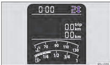
Fig. 75 En el panel de instrumentos : indicador de cambio de marcha (variante 1).
