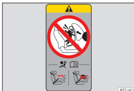
Fig. 38 En el pilar B: etiqueta adhesiva relativa al airbag (representación esquemática).
