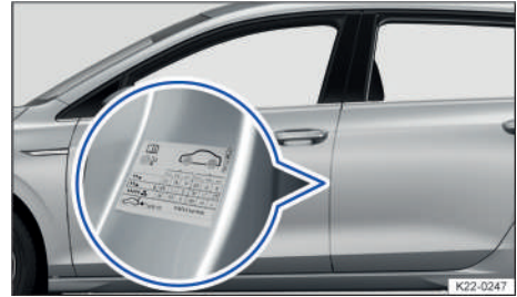
Fig. 183 En el pilar de la puerta del conductor: adhesivo de la presión de los neumáticos (o en la cara interior de la tapa del depósito de combustible).
