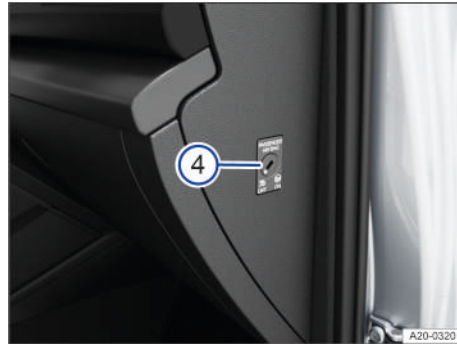
Fig. 8 Con la puerta del acompañante abierta: conmutador de llave en el tablero de instrumentos.
