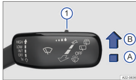
Fig. 81 En el lado derecho de la columna de dirección: palanca del limpiacristales.
