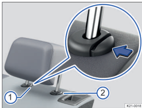
Fig. 70 Desmontaje de los apoyacabezas traseros (representación esquemática).
