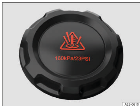
Fig. 178 En el vano delantero: tapa del depósito de expansión del líquido refrigerante (representación esquemática).
