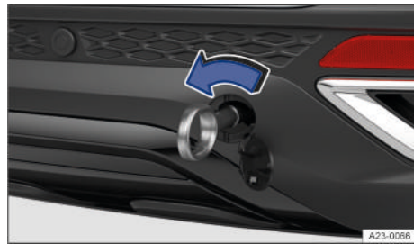
Fig. 168 En el lado derecho del paragolpes trasero: enroscar la argolla de remolque.
