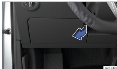
Fig. 159 En el tablero de instrumentos del lado del conductor: tapa de la caja de fusibles (representación esquemática).
