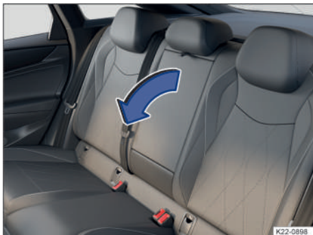
Fig. 129 En el respaldo de la plaza central del asiento: reposabrazos central trasero abatible (representación esquemática).
