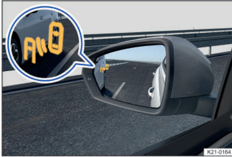
Fig. 118 En los espejos de los retrovisores exteriores: indicación del detector de ángulo muerto.
