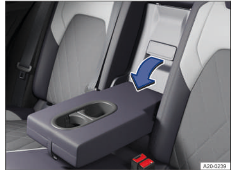
Fig. 139 En el respaldo del asiento trasero: trampilla para cargas largas (representación esquemática).
