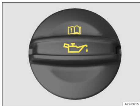
Fig. 176 En el vano delantero: tapa de la boca de llenado de aceite del motor (representación esquemática).
