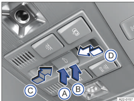
Fig. 60 En el revestimiento interior del techo: tecla del techo de cristal.
