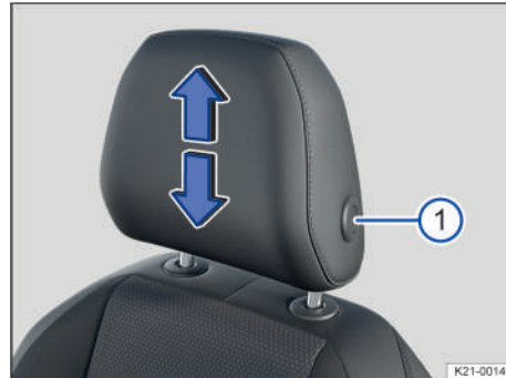
Fig. 67 Desmontaje de los apoyacabezas delanteros (representación esquemática).
