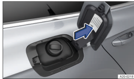
Fig. 145 En la cara interior de la tapa del depósito de combustible: adhesivo del combustible (representación esquemática).
