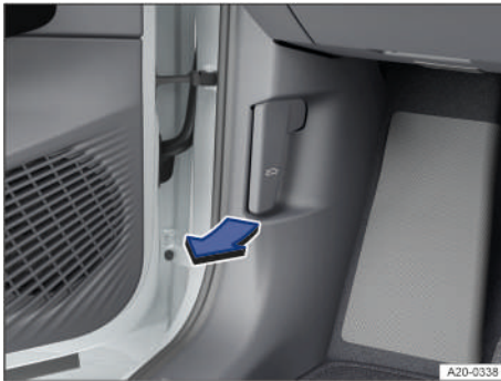
Fig. 169 En la zona reposapiés del lado del conductor: palanca de desbloqueo del capó delantero (representación esquemática).
