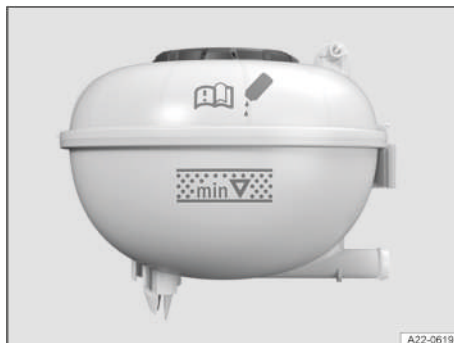
Fig. 179 En el vano delantero: marcas en el depósito de expansión del líquido refrigerante (representación esquemática).
