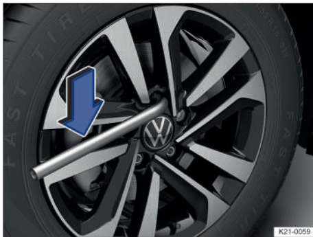
Fig. 194 Aflojar los tornillos de rueda.
