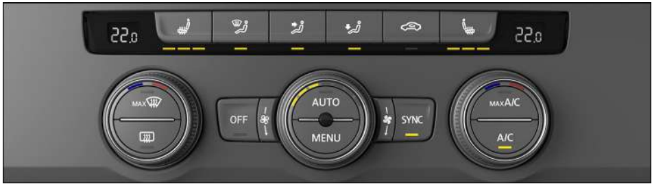
Fig. 88 En la parte superior de la consola central: panel de mandos del Climatronic (variante 2).
