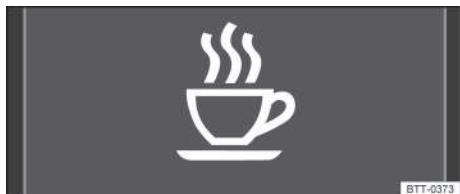
Fig. 20 En la pantalla del cuadro de instrumentos: símbolo de detección del cansancio.
