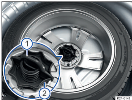
Fig. 190 Debajo del piso del maletero: ruedecilla para fijar la rueda de repuesto o la rueda de emergencia.
