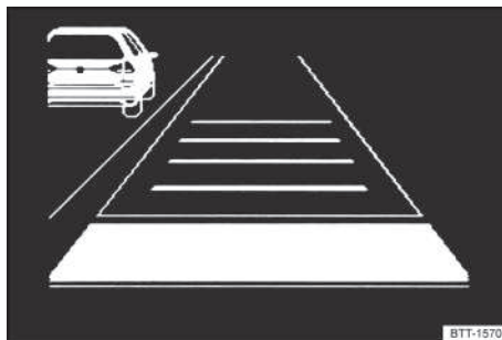
Fig. 112 En la pantalla del cuadro de instrumentos: vehículo detectado que circula más lentamente que el propio por el carril izquierdo (representación esquemática).
