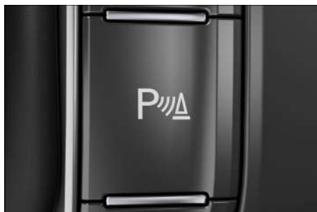
Fig. 121 En la consola central: tecla de la ayuda de aparcamiento (en función del equipamiento).
