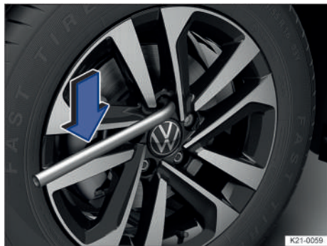
Fig. 198 Desenroscar los tornillos de rueda con la llave de rueda.
