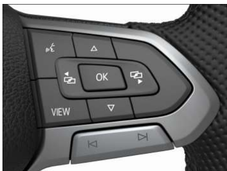
Fig. 10 Lado derecho del volante multifunción: manejo del cuadro de instrumentos digital Pro (variante 1).
