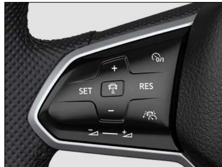
Fig. 111 Lado izquierdo del volante multifunción (variante 2).
