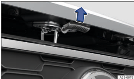
Fig. 170 Encima de la parrilla del radiador: palanca de accionamiento del capó delantero (representación esquemática).
