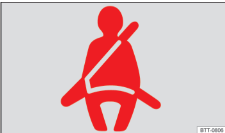
Fig. 22 En la pantalla del cuadro de instrumentos: testigo de advertencia del recordatorio de abrocharse el cinturón de seguridad.
