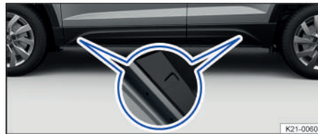
Fig. 195 En el larguero inferior: marcas para los puntos de alojamiento del gato.
