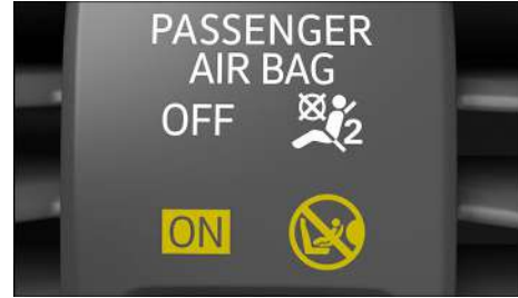
Fig. 31 En la consola central: testigo de control de la activación del airbag frontal del acompañante (en función del país).
