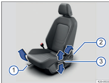
Fig. 63 En el asiento del conductor: mandos.
