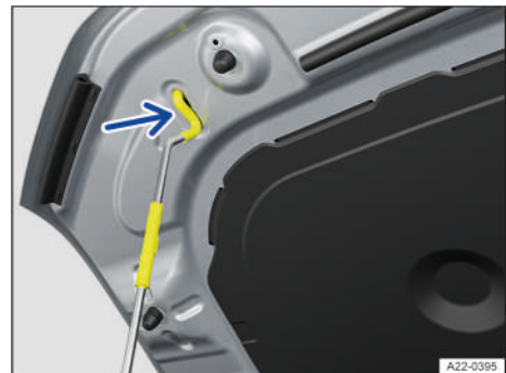
Fig. 172 En el capó delantero: alojamiento de la varilla de sujeción del capó (representación esquemática).
