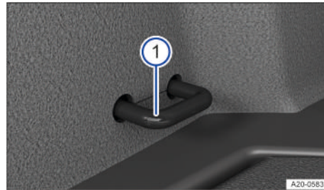
Fig. 137 En el maletero: argollas de amarre (representación esquemática).
