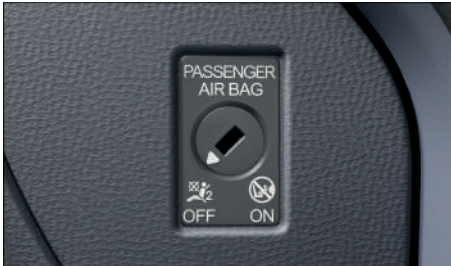
Fig. 30 En el tablero de instrumentos, en el lado del acompañante: conmutador de llave para desactivar y activar el airbag frontal del acompañante.
