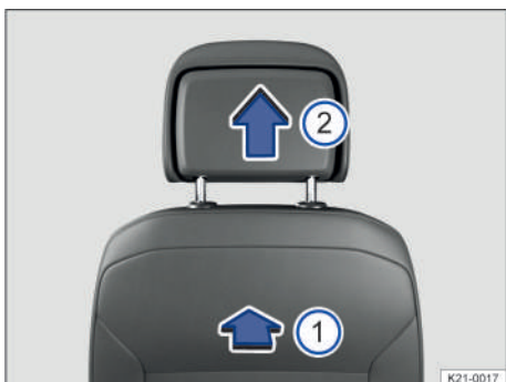
Fig. 69 Desmontaje de los apoyacabezas delanteros (representación esquemática).
