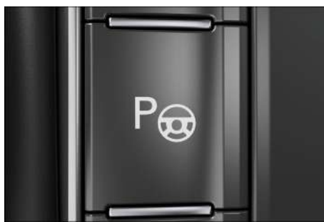
Fig. 123 En la consola central: tecla del Park Assist (en función del equipamiento).
