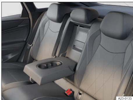
Fig. 130 En el reposabrazos central trasero: portabebidas (representación esquemática).
