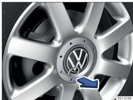
Fig. 191 Desmontar el tapacubos central tirando de él.
