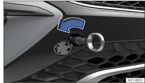
Fig. 166 En el lado derecho del paragolpes delantero: enroskar la argolla de remolque.
