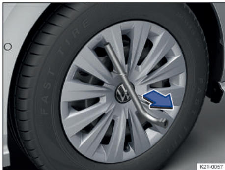
Fig. 192 Desmontar el tapacubos integral.
