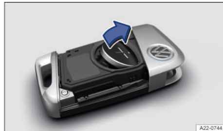
Fig. 47 Llave del vehículo: cambiar la pila de botón.
