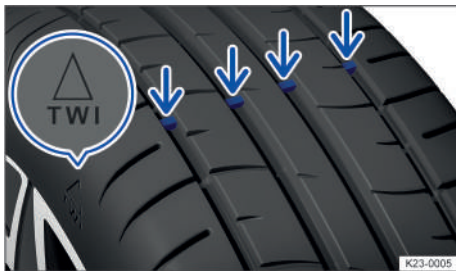
Fig. 187 En las acanaladuras del perfil: indicadores de desgaste.
