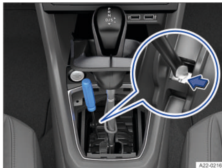
Fig. 96 En la consola central: realizar un desbloqueo de emergencia de la palanca selectora (variante 1).
