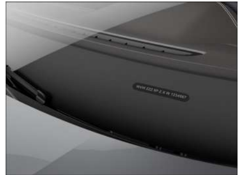
Fig. 246 En el parabrisas: número de identificación del vehículo.
