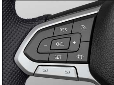
Fig. 110 Lado izquierdo del volante multifunción (variante 1).
