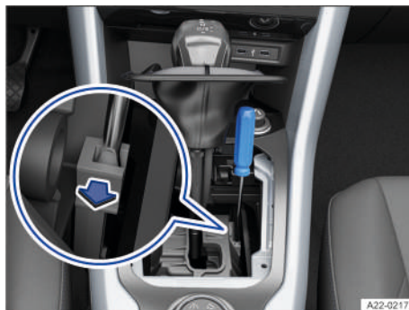
Fig. 97 En la consola central: realizar un desbloqueo de emergencia de la palanca selectora (variante 2).
