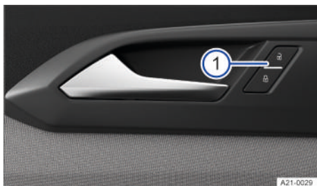
Fig. 50 En la puerta del conductor: tecla del cierre centralizado (representación esquemática).
