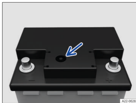
Fig. 181 En la parte superior de la batería de 12 voltios: mirilla (representación esquemática).
