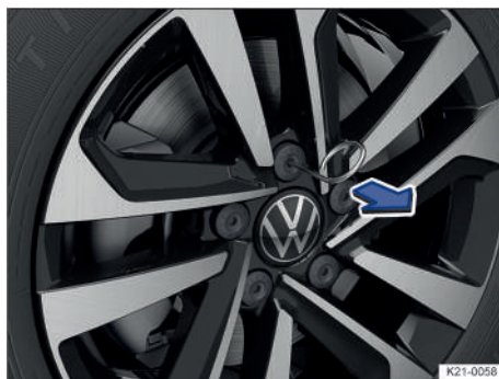
Fig. 193 Retirar las caperuzas de los tornillos de rueda.
