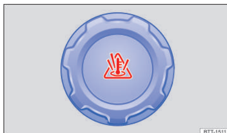
Fig. 223 En el compartimento del motor: tapa del depósito de expansión del líquido refrigerante del motor.
