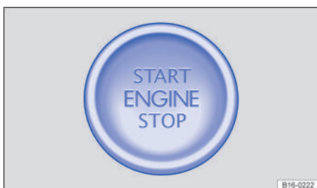
Fig. 92 En la parte inferior de la consola central: tecla de arranque para poner en marcha el motor
