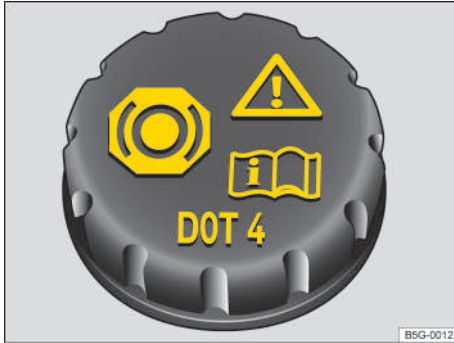
Fig. 224 En el compartimento del motor: tapón de cierre del depósito del líquido de frenos.
