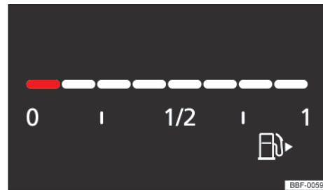
Fig. 12 En el instrumento combinado digital: indicador del nivel de combustible (variante 2).
