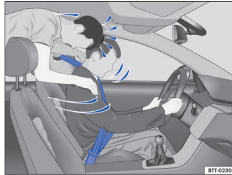
Fig. 25 El pasajero sin cinturón de seguridad en el asiento trasero es lanzado hacia adelante sobre el conductor con cinturón de seguridad.
