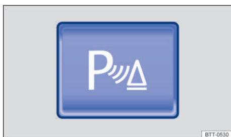
Fig. 107 En la consola central: tecla de encender y apagar la ayuda de aparcamiento.
