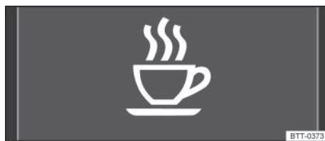
Fig. 15 En el display del instrumento combinado: símbolo del sistema de detección del cansancio.
