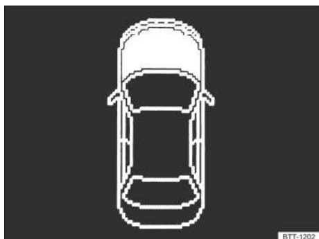
Fig. 218 En la pantalla del instrumento combinado: tapa del compartimento del motor abierta o cerrada incorrectamente (representación esquemática).
