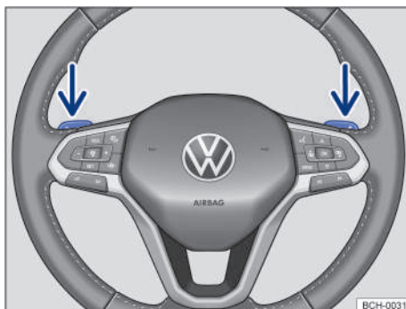
Fig. 99 Volante con selectores basculantes de Tiptronic.
