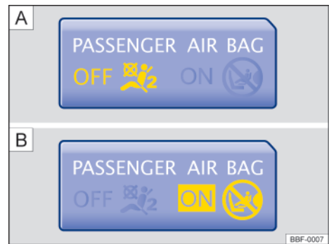
Fig. 32 En la parte superior de la consola central: luz de control para el airbag frontal del acompañante delantero apagada [A] o luz de control para el airbag frontal del acompañante delantero encendida [B].
