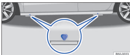
Fig. 235 Puntos de apoyo del gato.
