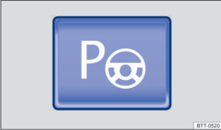
Fig. 110 En la consola central: tecla de encender el asistente de dirección de ayuda para aparcamiento.
