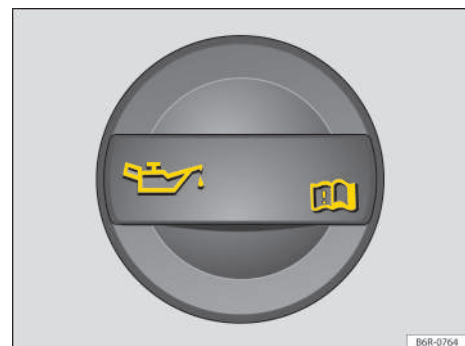
Fig. 221 En el compartimento del motor: tapón de la boca de llenado del aceite del motor. ▶
