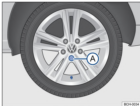
Fig. 198 Cambio de rueda: secuencia de desmontaje de los tornillos de la rueda.
