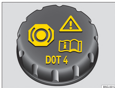
Fig. 186 En el compartimento del motor: tapón de cierre del depósito del líquido de frenos.
