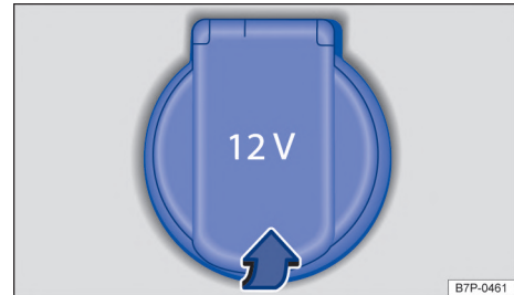
Fig. 115 En la consola central delantera: toma de corriente de 12 V.
