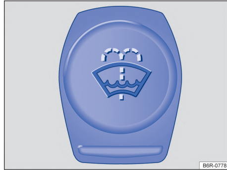
Fig. 181 En el compartimento del motor: tapón de cierre del depósito de agua de los lavacrystales.
