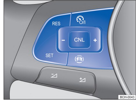
Fig. 98 Lado izquierdo del volante multifunción (variante 1): teclas para controlar el limitador de velocidad.
