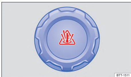
Fig. 185 En el compartimento del motor: tapa del depósito de expansión del líquido refrigerante del motor.
