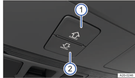
Fig. 86 En el revestimiento interior del techo: teclas para manejar la cortinilla parasol.
