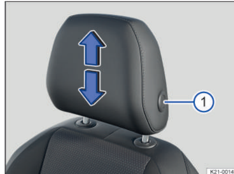
Fig. 67 Desmontaje de los apoyacabezas delanteros (representación esquemática).
