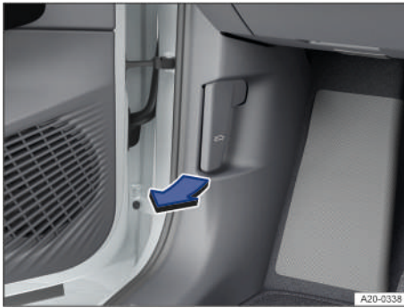
Fig. 169 En la zona reposapiés del lado del conductor: palanca de desbloqueo del capó delantero (representación esquemática).
