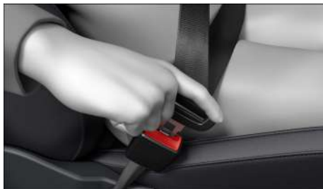
Fig. 23 Insertar la lengüeta del cinturón de seguridad en su cierre (representación esquemática).
