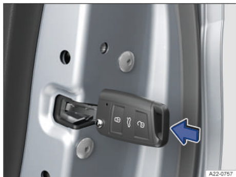
Fig. 53 En el frontal de una puerta: bloqueo de emergencia del vehículo con el paletón de la llave o la llave de emergencia (variante 2).
