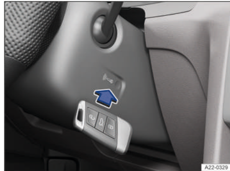
Fig. 91 En el lado derecho de la columna de dirección: función de arranque de emergencia en los vehículos con el sistema de cierre y arranque sin llave "Keyless Access".
