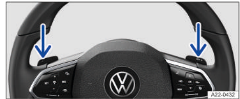
Fig. 95 Detrás del volante: levas de cambio para el Tiptronic.
