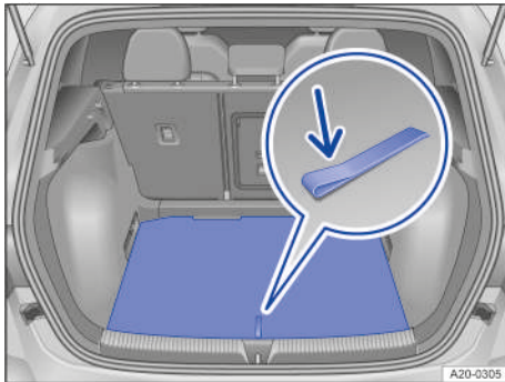
Fig. 136 En el maletero: abrir el piso del maletero.
