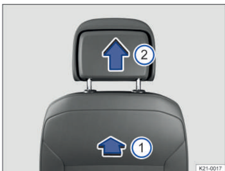
Fig. 69 Desmontaje de los apoyacabezas delanteros (representación esquemática).
