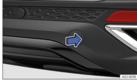
Fig. 167 En el lado derecho del paragolpes trasero: retirar la tapa.
