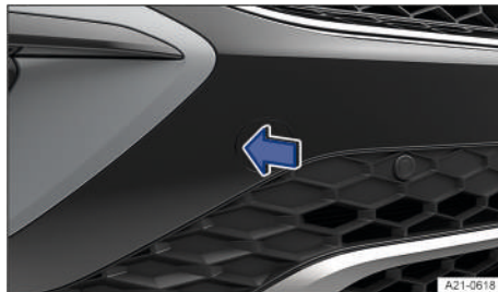
Fig. 165 En el lado derecho del paragolpes delantero: retirar la tapa.
