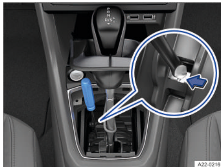
Fig. 96 En la consola central: realizar un desbloqueo de emergencia de la palanca selector (variante 1).
