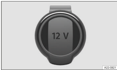
Fig. 131 En el portaobjetos delantero o en el lado izquierdo del maletero: toma de corriente de 12 voltios con tapa plegable (representación esquemática).
