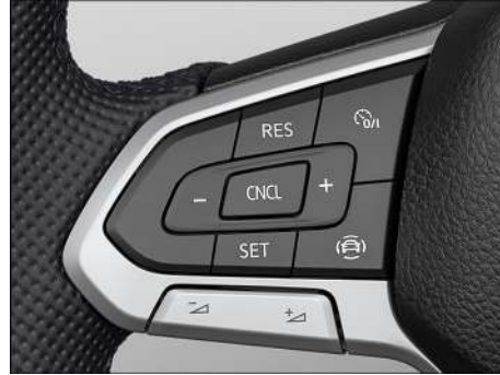
Fig. 110 Lado izquierdo del volante multifunción (variante 1).
