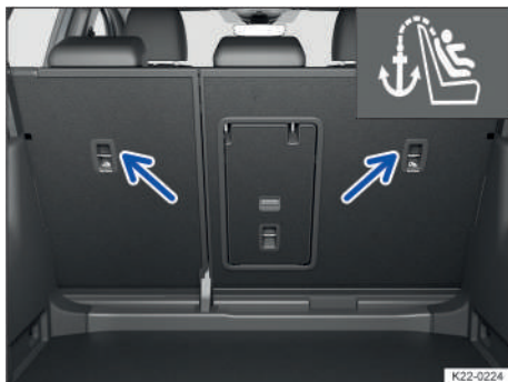
Fig. 40 En la parte posterior del asiento trasero: anclajes Top Tether para el cinturón de fijación superior Top Tether.
