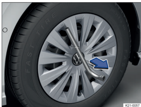
Fig. 192 Desmontar el tapacubos integral.
