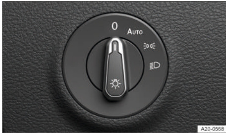
Fig. 75 Junto al volante: mando de las luces.
