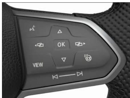
Fig. 11 Lado derecho del volante multifunción: manejo del cuadro de instrumentos digital Pro (variante 2).
