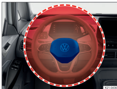
Fig. 28 En el lado del conductor: ubicación y zona de despliegue del airbag frontal del conductor.
