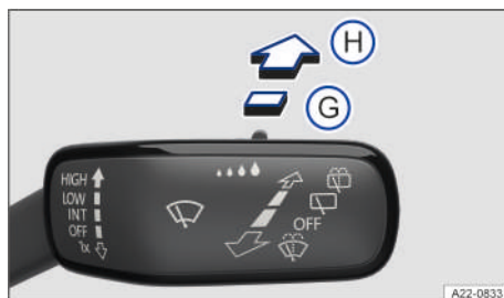
Fig. 80 En el lado derecho de la columna de dirección: manejo del limpiacristales.
