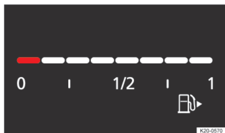
Fig. 16 En el cuadro de instrumentos digital Basic: indicador del nivel de combustible (representación esquemática).
