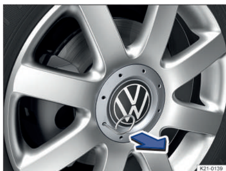
Fig. 191 Desmontar el tapacubos central tirando de él.
