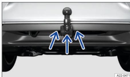
Fig. 141 En el dispositivo de remolque: argolla para fijar el cable de seguridad o el de ruptura (representación esquemática).
