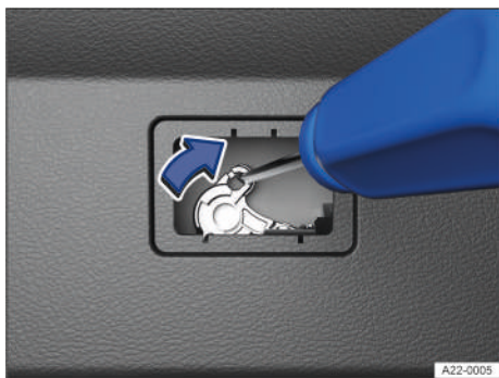
Fig. 58 En el maletero: desbloqueo de emergencia del portón.
