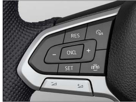
Fig. 108 Lado izquierdo del volante multifunción (variante 1).
