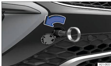
Fig. 166 En el lado derecho del paragolpes delantero: enroskar la argolla de remolque.
