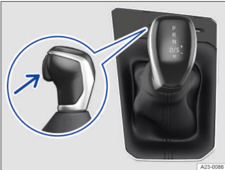
Fig. 93 En la consola central: palanca selectora del cambio automático (representación esquemática).
