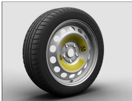
Fig. 184 Rueda de repuesto de tamaño reducido.
