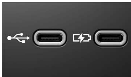
Fig. 133 Conexión USB-C disponible en el vehículo (representación estándar).
