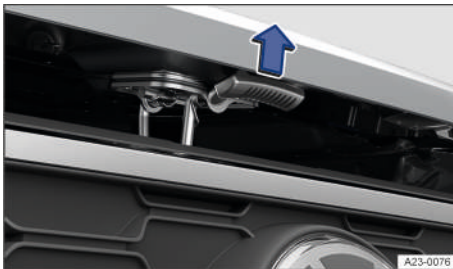
Fig. 170 Encima de la parrilla del radiador: palanca de accionamiento del capó delantero (representación esquemática).
