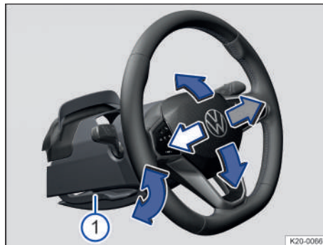
Fig. 61 Debajo del volante, en el guardanicho de la columna de dirección: palanca para el ajuste manual de la posición del volante (representación esquemática).
