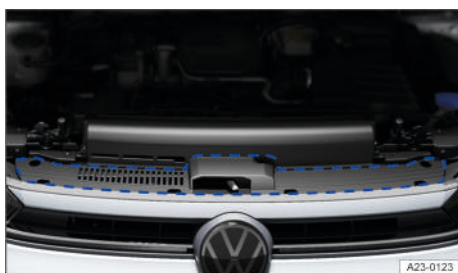
Fig. 174 En la zona marcada: ubicación del adhesivo con la norma y la viscosidad del aceite del motor (representación esquemática).
