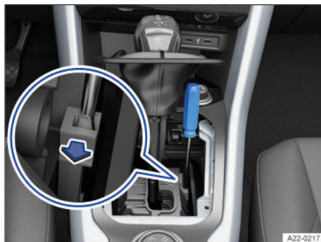
Fig. 97 En la consola central: realizar un desbloqueo de emergencia de la palanca selector (variante 2).
