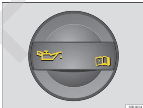
Fig. 127 En el compartimento del motor: tapón de la boca de llenado del aceite del motor.
