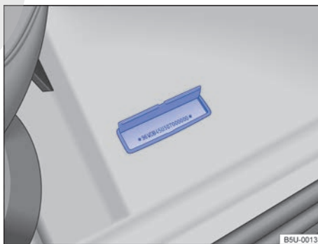
Fig. 179 Delante del asiento del acompañante delantero: número de identificación del vehículo (número del chasis) en el piso, delante del asiento del acompañante delantero.
