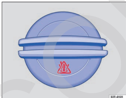
Fig. 131 En el compartimento del motor: tapa del depósito de expansión del líquido refrigerante del motor.
