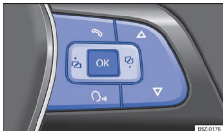
Fig. 16 Lado derecho del volante multifunción: teclas de comando.
