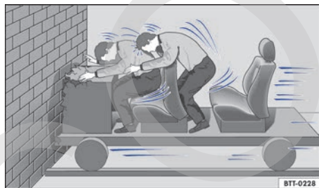
Fig. 44 Un vehículo con los ocupantes del vehículo sin cinturones de seguridad choca contra el muro.
