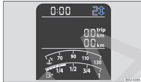
Fig. 100 En el panel de instrumentos : indicador de cambio de marcha (variante 1).
