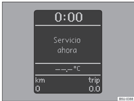
Fig. 11 Display del panel de instrumentos: indicador del intervalo de servicio.
