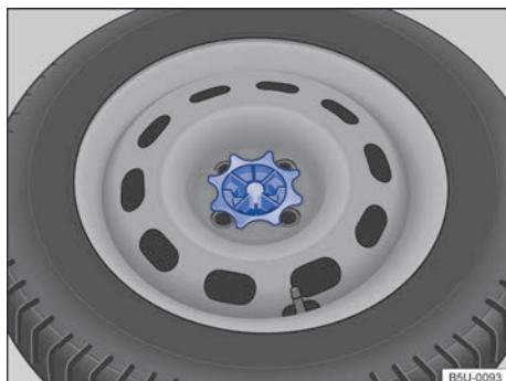
Fig. 138 En el maletero: manivela para fijación de la rueda de emergencia.
