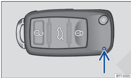
Fig. 20 Luz de control de la llave del vehículo con comando remoto.
