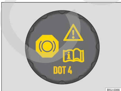
Fig. 109 En el compartimento del motor: tapón de cierre del depósito del líquido de frenos.
