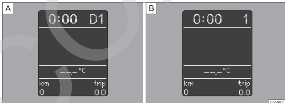
Fig. 102 A Posiciones de la palanca selectora en el display: indicación de la palanca en modo de conducción automatizada (Modo normal), en 1ª marcha. B Posiciones de la palanca selectora en el display: modo de conducción manual, con la 1ª marcha seleccionada.
