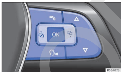
Fig. 49 Lado derecho del volante multifunción: teclas de mando de los menús del panel de instrumentos.
