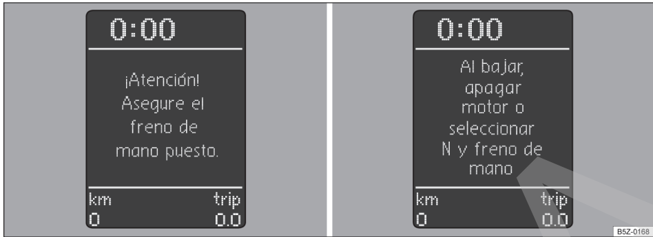
Fig. 106 Display del cuadro instrumentos: textos de advertencia.
