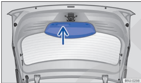
Fig. 65 Tapa trasera abierta: tirador para cierre.
