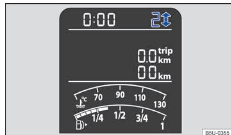
Fig. 95 En el panel de instrumentos : indicador de cambio de marcha (variante 1).
