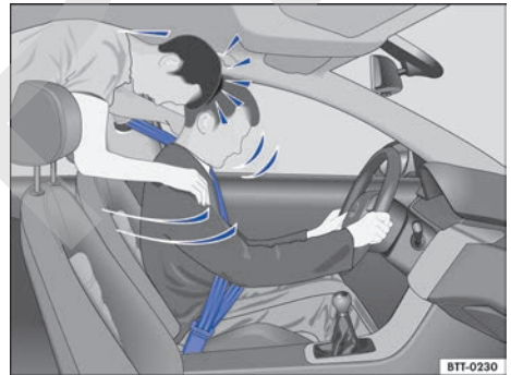
Fig. 7 El pasajero sin cinturón de seguridad en el asiento trasero es lanzado hacia adelante sobre el conductor con cinturón de seguridad.
