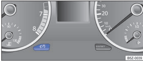
Fig. 79 En el panel de instrumentos: tecla de regulación de la iluminación de los instrumentos y de los interruptores.
