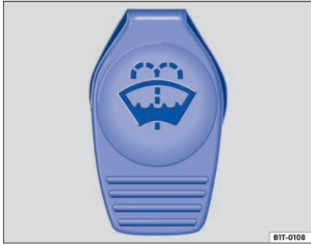
Fig. 153 En el compartimento del motor: tapón de cierre del depósito de agua de los lavavidrios.
