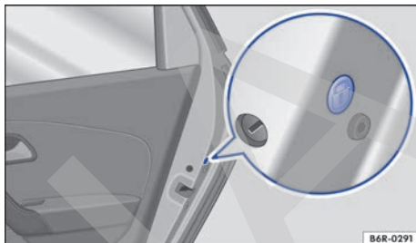
Fig. 61 En la puerta trasera: cierre de emergencia, cubierto por un burlete de goma.
