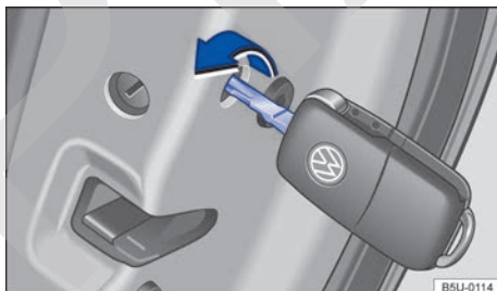
Fig. 62 Cierre de emergencia del vehículo con la llave del vehículo.
