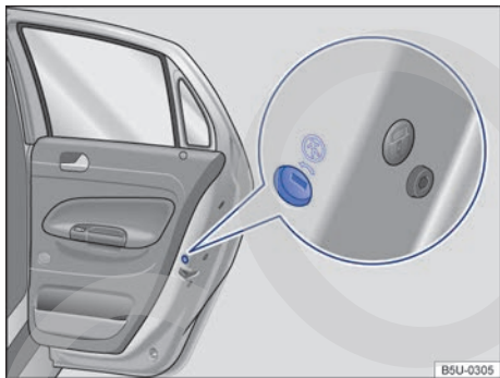
Fig. 24 En la puerta trasera (lado derecho): ubicación del seguro para niños.
