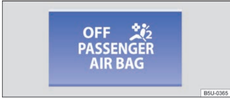
Fig. 15 Luz de control en el panel de instrumentos para el airbag frontal del pasajero desconectado.
