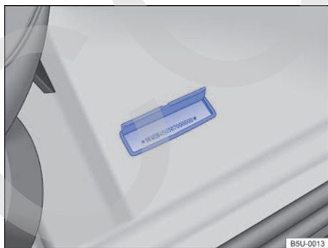
Fig. 175 Delante del asiento del acompañante delantero: número de identificación del vehículo (número del chasis) en el piso, delante del asiento del acompañante delantero.
