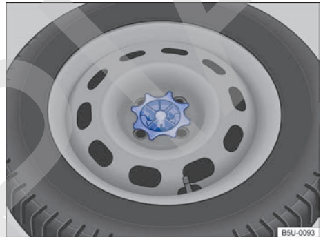
Fig. 165 En el maletero: manivela para fijación de la rueda de emergencia.
