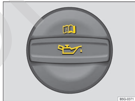
Fig. 150 En el compartimento del motor: tapa de la boca de llenado de aceite (representación esquemática).
