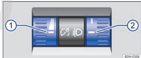
Fig. 79 Junto al volante: regulador de la iluminación de los instrumentos y los mandos ① y regulador del alcance de las luces ②.
