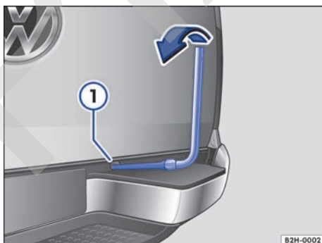
Fig. 178 Bajar la rueda de auxilio mediante el malacate.
