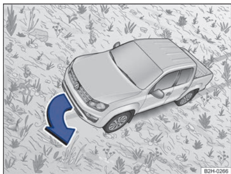
Fig. 145 Girar hacia la línea de caída.
