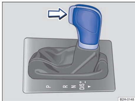
Fig. 113 Vehículos con el volante a la izquierda: palanca selectora del cambio automático con tecla de bloqueo (flecha).
