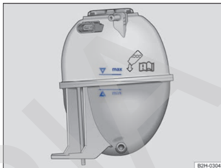
Fig. 152 En el compartimento del motor: marcas en el depósito de expansión del líquido refrigerante del motor (representación esquemática).
