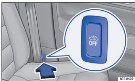
Fig. 21 Junto al asiento del conductor, en el pilar B: tecla para desconectar la vigilancia del habitáculo y el sistema antirremolcado.
