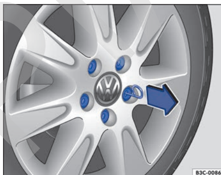
Fig. 176 Quitar los capuchones de los tornillos de rueda.
