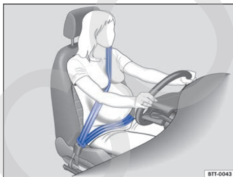
Fig. 63 Colocación correcta de la banda del cinturón en el caso de mujeres embarazadas.
