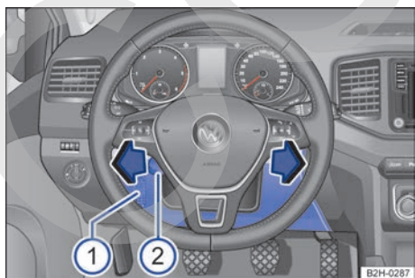
Fig. 192 Caja de fusibles detrás del revestimiento del tablero de instrumentos ①.
