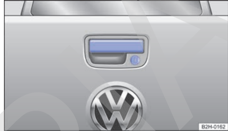
Fig. 24 Apertura del portón de carga desde el exterior.
