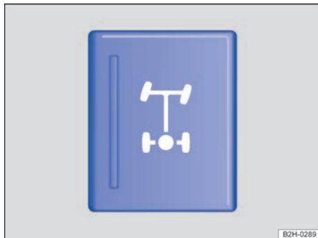
Fig. 143 En la consola central: tecla del bloqueo del diferencial del eje trasero.
