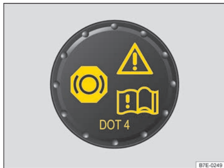
Fig. 118 En el compartimento del motor: tapa del depósito del líquido de frenos.
