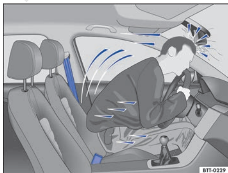
Fig. 53 El conductor sin el cinturón de seguridad colocado sale lanzado hacia adelante.
