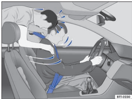
Fig. 54 El ocupante del asiento trasero sin el cinturón de seguridad colocado sale lanzado hacia adelante topando contra el conductor, que sí lo lleva colocado.
