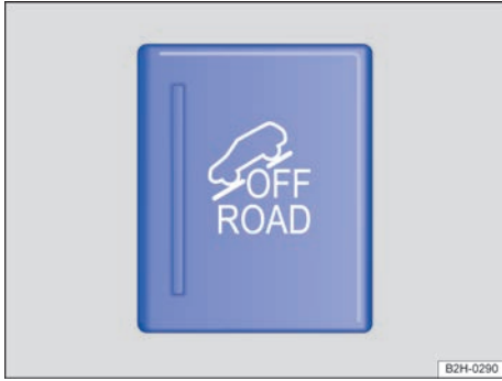
Fig. 144 En la consola central: tecla para conectar y desconectar manualmente la función fuera de carretera.
