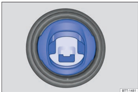
Fig. 136 En la boca de llenado del tanque de combustible: protección contra carga de combustible equivocado.
