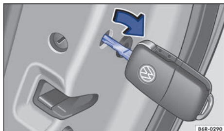
Fig. 169 Bloqueo de emergencia del vehículo con la llave del vehículo.
