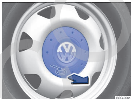
Fig. 175 Desmontar la taza de rueda central tirando de ella.
