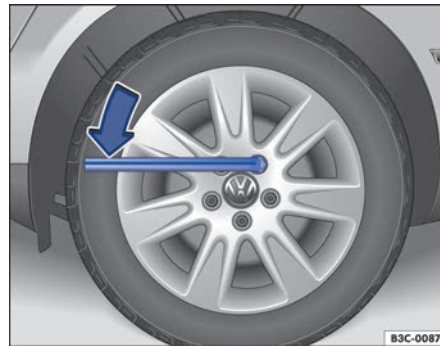
Fig. 181 Cambio de rueda: aflojar los tornillos de rueda.
