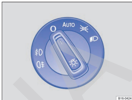
Fig. 78 Junto al volante: mando de las luces (una variante).
