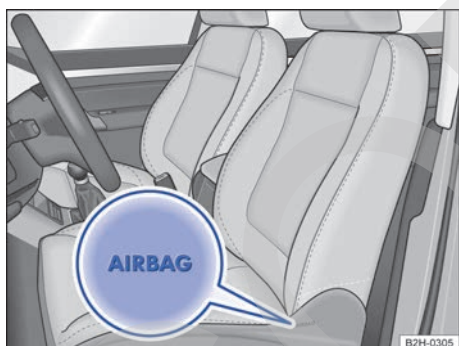
Fig. 70 Lateral de un asiento delantero: ubicación del airbag lateral para la cabeza y el tórax.
