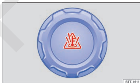
Fig. 153 En el compartimento del motor: tapa del depósito de expansión del líquido refrigerante.
