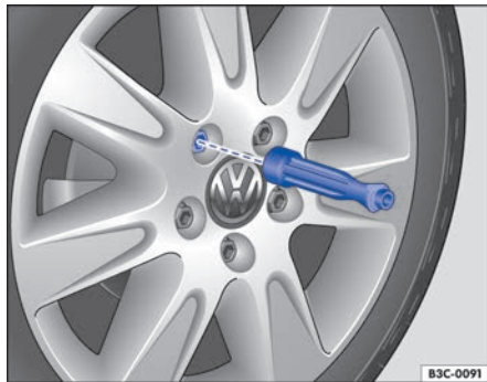
Fig. 188 Cambio de rueda: desenroscar los tornillos de rueda con el mango del destornillador.
