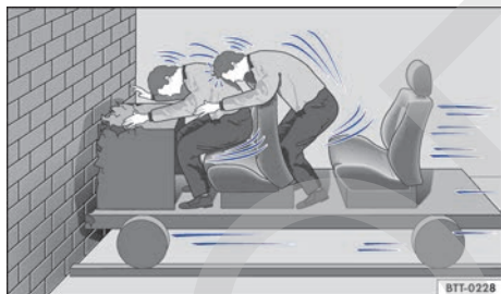
Fig. 52 El vehículo choca contra el muro. Los ocupantes no llevan colocado el cinturón de seguridad.
