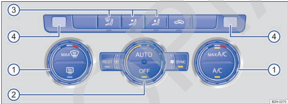
Fig. 128 En el tablero de instrumentos: mandos del Climatronic.
