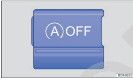
Fig. 120 En la consola central: tecla del sistema Start-Stop.
