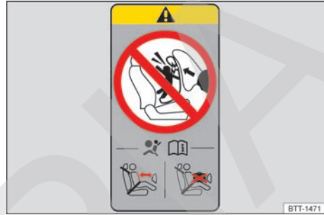
Fig. 72 Etiqueta adhesiva relativa al airbag en el pilar B (representación esquemática).
