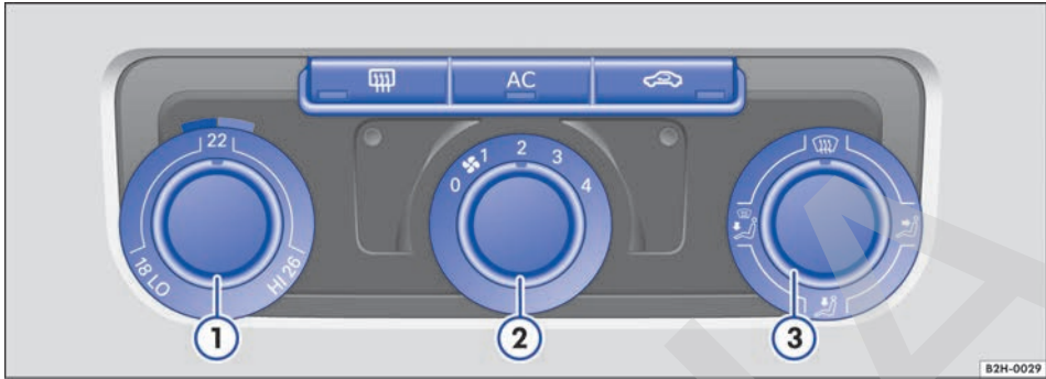
Fig. 127 En el tablero de instrumentos: mandos del Climatic.
