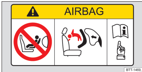
Fig. 71 Etiqueta adhesiva relativa al airbag en el parasol (representación esquemática).
