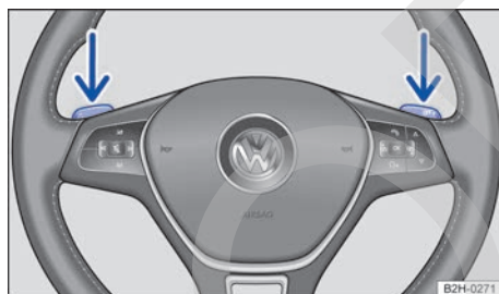
Fig. 115 Volante con palancas de cambio para el Tiptronic.
