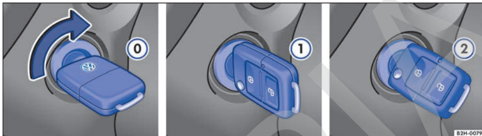
Fig. 109 Posiciones de la llave del vehículo en la cerradura de encendido.
