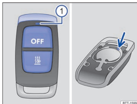
Fig. 131 Calefacción independiente: mando a distancia por radiofrecuencia. ▶
