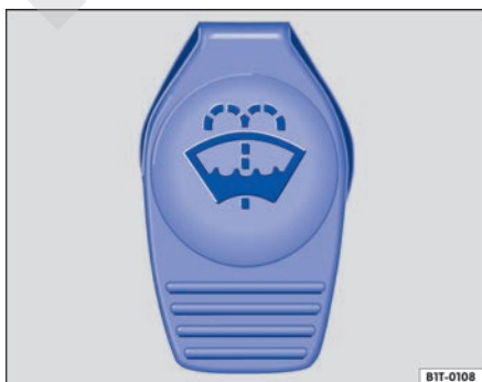
Fig. 87 En el compartimento del motor: tapa del depósito del líquido lavacrystales.
