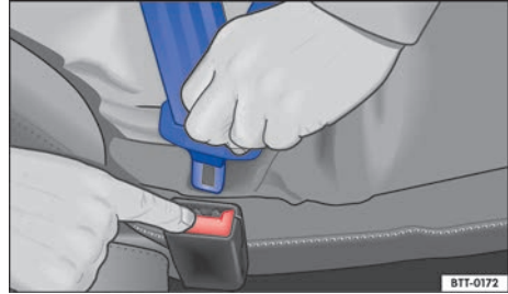
Fig. 57 Soltar la lengüeta del cierre del cinturón.
