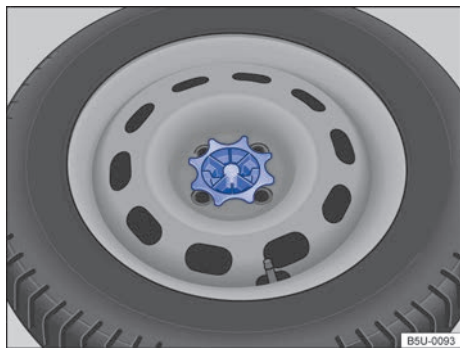
Fig. 134 En el maletero: manivela para fijación de la rueda de emergencia.
