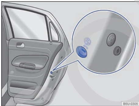
Fig. 57 En la puerta trasera (lado derecho): ubicación del seguro para niños.
