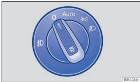
Fig. 59 En el panel: conmutador de las luces.
