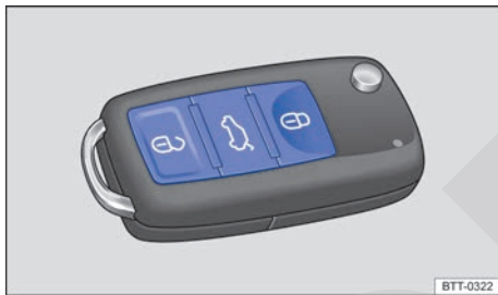
Fig. 24 Teclas en la llave del vehículo con mando a distancia.
