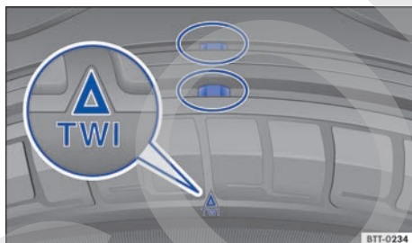
Fig. 133 Perfil del neumático: indicadores de desgaste.
