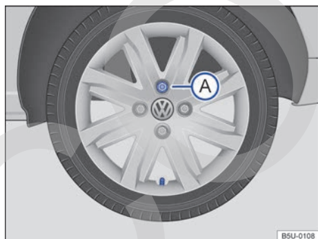
Fig. 140 Cambio de rueda: secuencia de desmontaje de los tornillos de la rueda.
