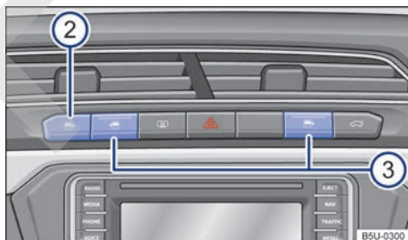
Fig. 31 En la consola central: teclas de los vidrios eléctricos traseros.
