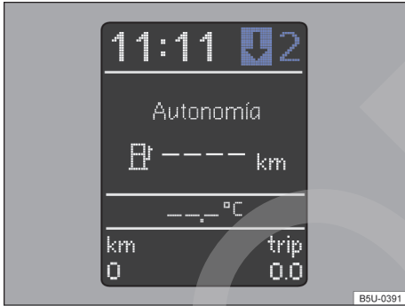
Fig. 97 En el panel de instrumentos : indicador de cambio de marcha (variante 2).
