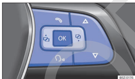
Fig. 13 Lado derecho del volante multifunción: teclas de mando de los menús del panel de instrumentos.
