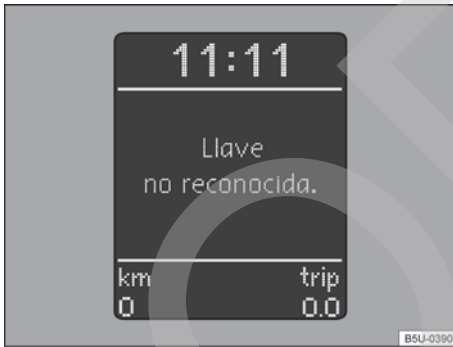
Fig. 92 En el panel de instrumentos: display con indicación del inmovilizador activado - vehículos con Sistema de Informaciones Volkswagen.
