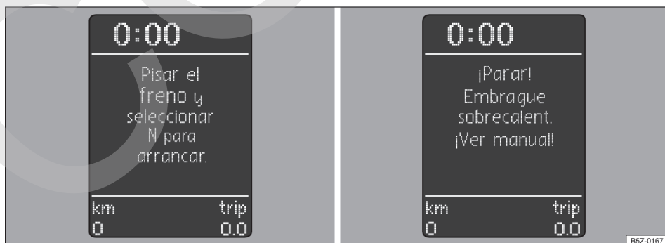
Fig. 102 Display del cuadro instrumentos: textos de advertencia. ▶
