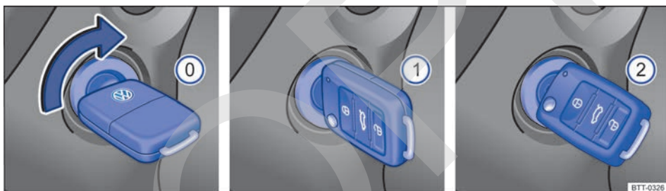
Fig. 91 Al lado del volante de la dirección, a la derecha: posiciones de la llave del vehículo en la cerradura de encendido.
