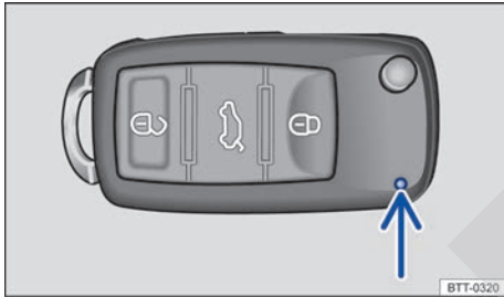
Fig. 20 Luz de control de la llave del vehículo con comando remoto.
