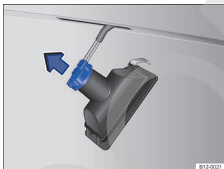
Fig. 170 Luz de la placa de licencia: retirar el portalámparas.
