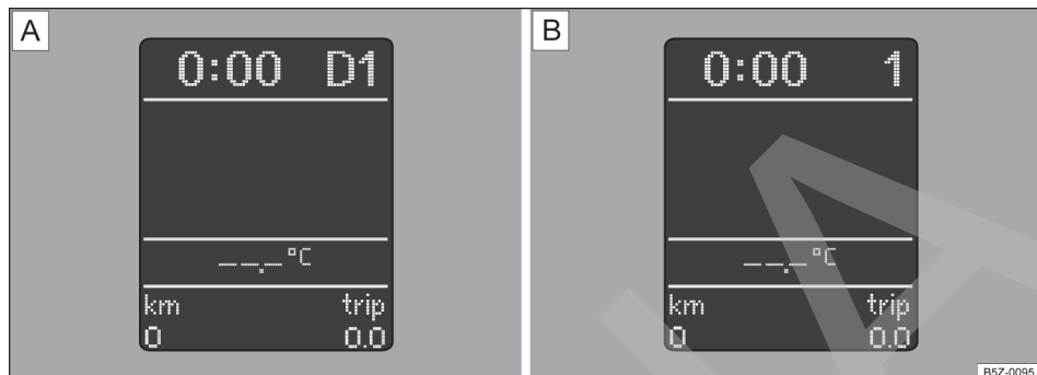
Fig. 98 A Posiciones de la palanca selectora en el display: indicación de la palanca en modo de conducción automatizada (Modo normal), en 1ª marcha. B Posiciones de la palanca selectora en el display: modo de conducción manual, con la 1ª marcha seleccionada.
