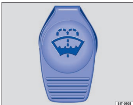
Fig. 67 En el compartimento del motor: tapón de cierre del depósito de agua de los lavavidrios.
