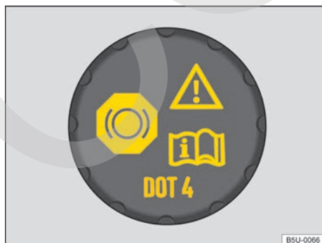
Fig. 105 En el compartimento del motor: tapón de cierre del depósito del líquido de frenos.
