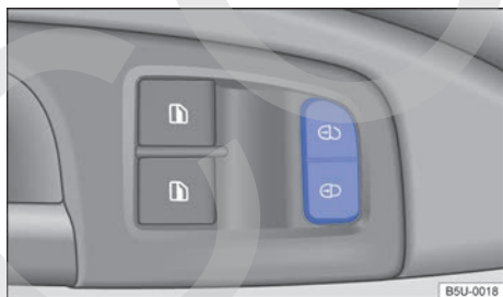
Fig. 25 En la puerta del conductor: teclas del cierre centralizado
