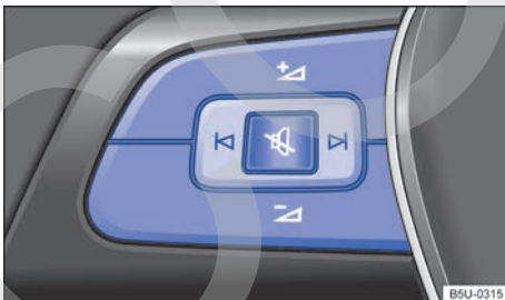
Fig. 15 Lado izquierdo del volante multifunción: teclas de comando.
