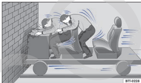
Fig. 43 Un vehículo con los ocupantes del vehículo sin cinturones de seguridad choca contra el muro.
