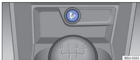
Fig. 89 En la consola central delantera: encendedor de cigarrillos.
