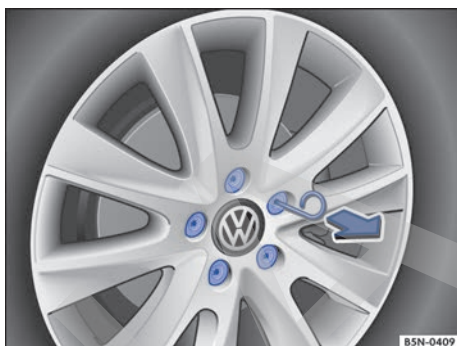
Fig. 169 Quitar los capuchones de los tornillos de rueda.
