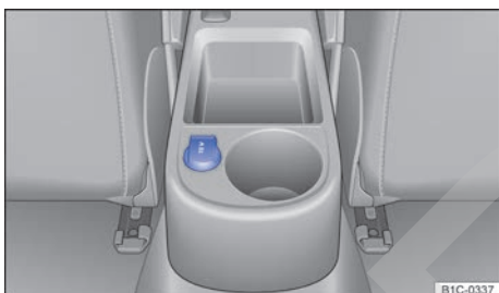
Fig. 98 Toma de corriente de 12 voltios en la parte trasera de la consola central.
