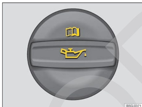
Fig. 138 En el vano motor: tapa de la boca de llenado de aceite.
