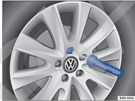
Fig. 174 Cambio de rueda: desenroscar los tornillos de rueda con el mango del destornillador.
