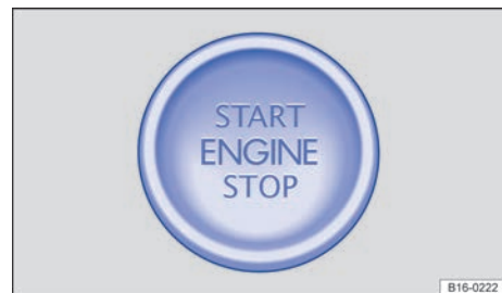
Fig. 100 En la consola central: pulsador de arranque del sistema de cierre y arranque Keyless Access.
