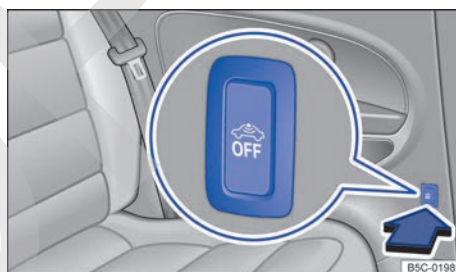
Fig. 25 Junto al asiento del conductor: tecla para desconectar la vigilancia del habitáculo y el sistema antirremolcado. ▶
