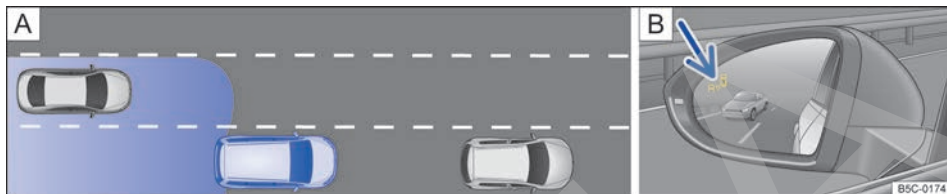
Fig. 123 Representación esquemática: A Situación en un adelantamiento con tráfico en la parte trasera. B Indicación del detector de ángulo muerto en el retrovisor exterior izquierdo.
