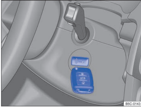
Fig. 101 En la columna de dirección: función de arranque de emergencia en vehículos con el sistema Keyless Access.
