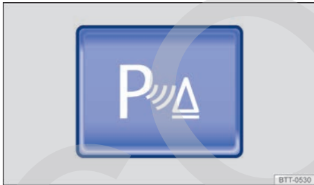
Fig. 114 En la parte superior de la consola central: tecla para conectar y desconectar el ParkPilot.
