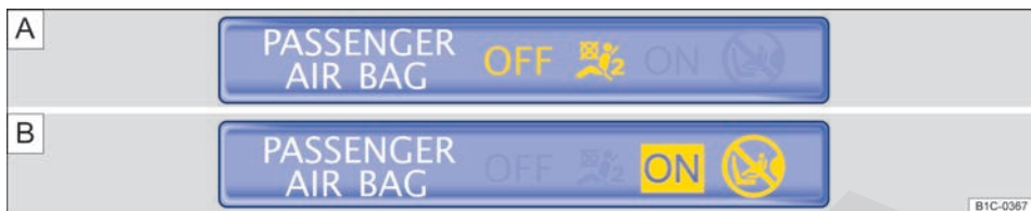
Fig. 58 Testigo de control en la parte superior de la consola central: A) Airbag frontal del acompañante desactivado; B) Airbag frontal del acompañante activado.
