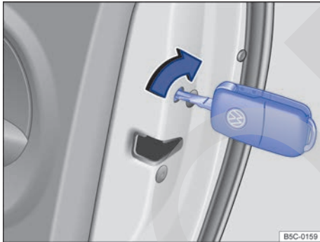
Fig. 159 En el frontal de la puerta del acompañante: bloqueo de emergencia de la puerta del acompañante con la llave del vehículo.
