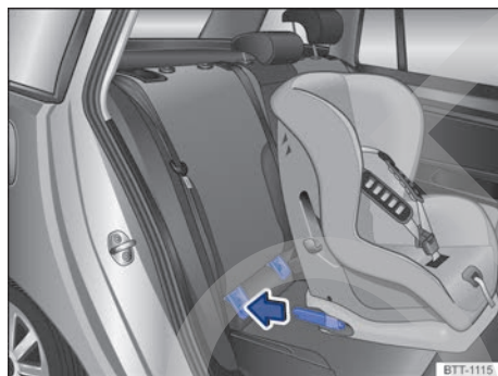
Fig. 68 Representación esquemática: montaje de un asiento para niños ISOFIX con conectores.
