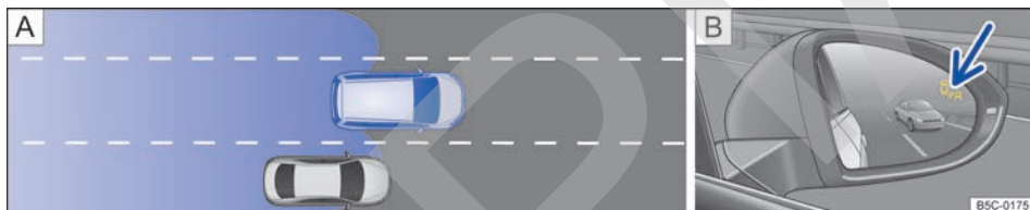
Fig. 124 Representación esquemática: A Situación en un adelantamiento e incorporación posterior al carril derecho. B Indicación del detector de ángulo muerto en el retrovisor exterior derecho.
